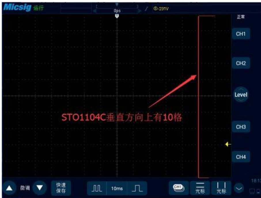
示波器垂直方向代表电压值
