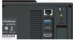
标配 USB 3.0 Host、Type-C、LAN、HDMI、校准方波输出接口（可切换 Trigger Out），满足用户多样化的连接需求，提升测试工作的灵活性与便捷性。
