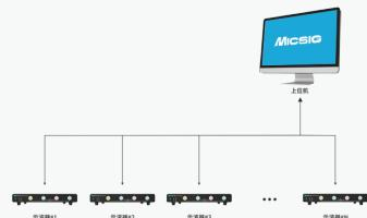
支持机架式安装，或者将 N 台机器进行矩阵式同步工作，从而实现更多的模拟通道数 (4\*N)。
