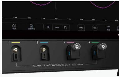
Mic-OPI™专利探头接口，易拔插，自动调节探头补偿。同时通过标配的转接头可兼容BNC接口，与所有探头连接。
