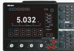
集成了4½位万用表功能，支持电压、电流、电阻、通断测试、二极管检测及电容测量等多种参数，无需额外携带万用表，即可满足多样化的测试需求。支持示波器与万用表同时运行且无缝切换，极大提升现场工作效率与便捷性。
