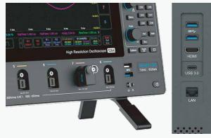
独创Mic-OPI™探头接口，一键自动补偿；标配BNC转接器，可适配任意BNC接口探头。配置USB 3.0/2.0 Host、USB Type-C、LAN、HDMI、Aux In/Out（支持外部触发输入、触发输出）、10MHz时钟信号In/Out等丰富端口。
