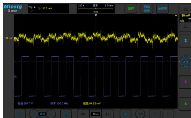
CH1: 在 100kHz, 207.7V 信号下输出的共模信号幅度 94.62mV, 共模抑制比 >-70dB
