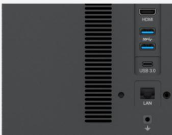
▶ 配有 USB 3.0 Host、USB Type-C、LAN、接地插孔、HDMI、Trigger out 等丰富端口
