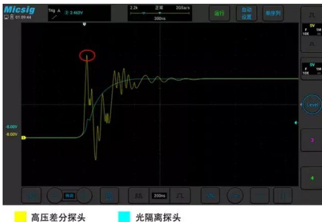
图 4：碳化硅导通瞬间的 V_{gs} 信号波形
