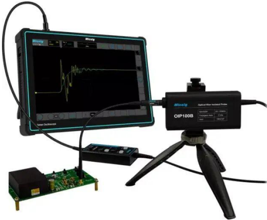
图 6: Micsig 基于 SigOFIT™ 专有技术的光隔离探头
