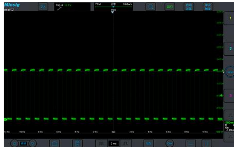
图 11-6 带毛刺的波形，正常采样模式
