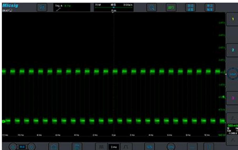
图 11-5 带毛刺的波形，峰值采样模式
