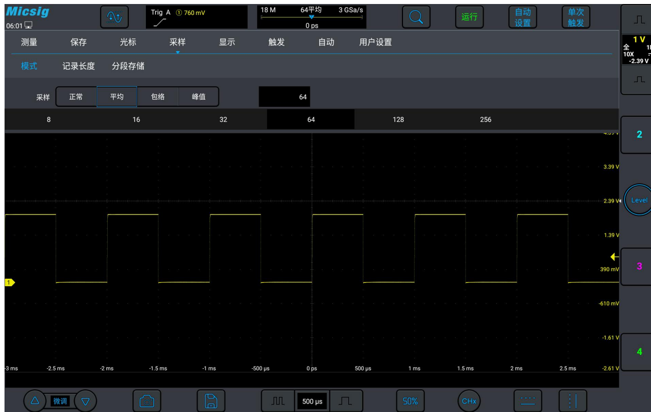
图 11-7 选择平均采样模式后的波形，平均数 64
