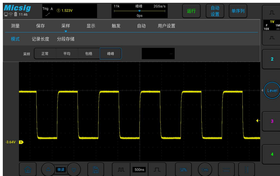
图 10-5 带毛刺的波形，峰值采样模式
