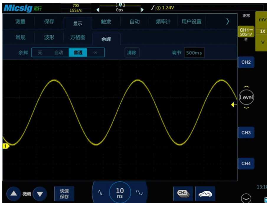
图10-4 20MHz 正弦波可变余辉 500ms 示图
