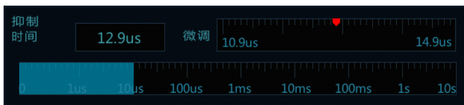
图6-10 触发抑制时间设置界面
