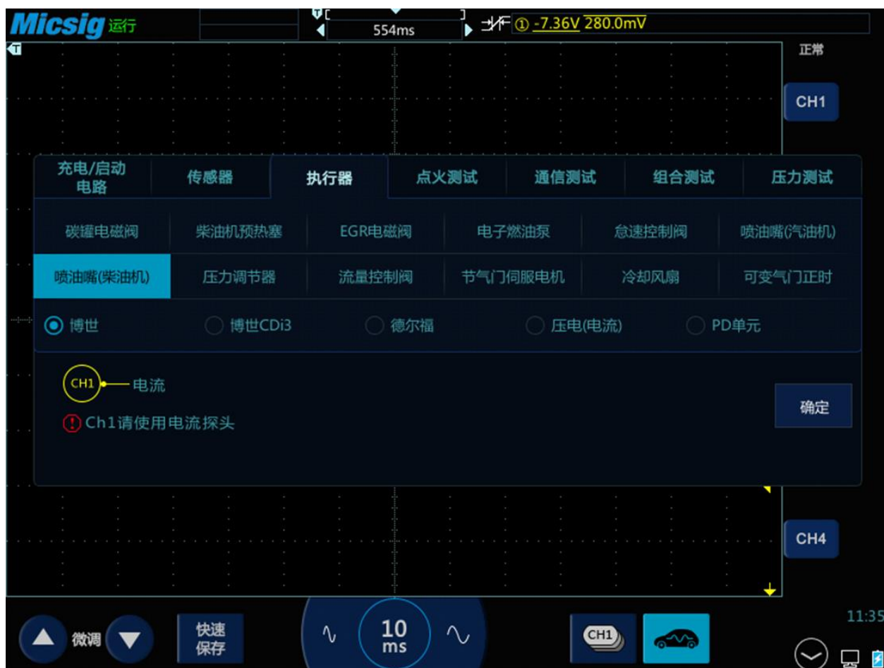
图3-36 喷油嘴（柴油机）测试
