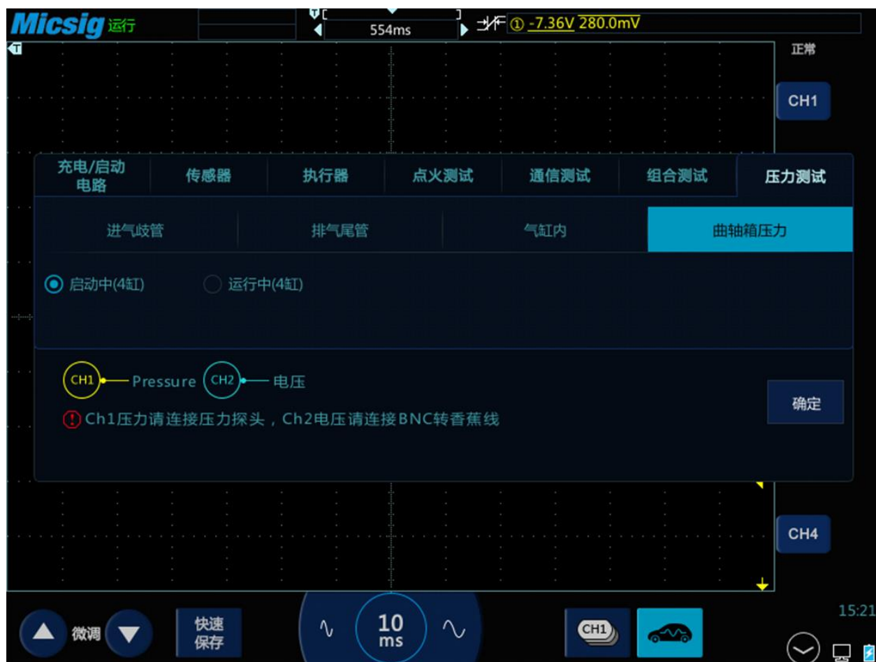
图3-63 曲轴箱压力和电压测试
