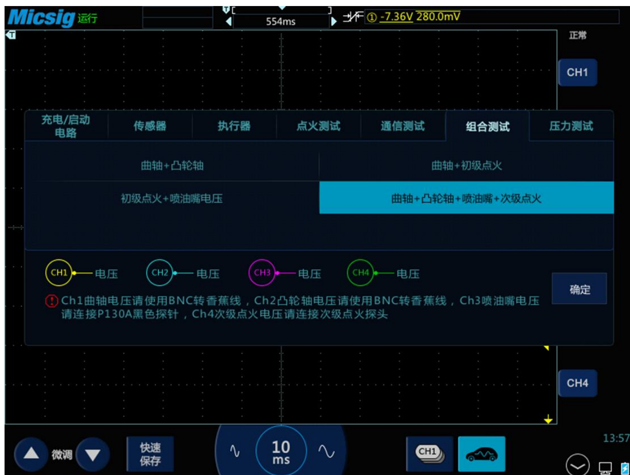
图3-58 曲轴+凸轮轴+喷油嘴+次级点火组合测试
