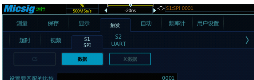
图14-18 SPI 触发方式配置菜单
