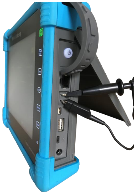
图2-12 探头连接方式
