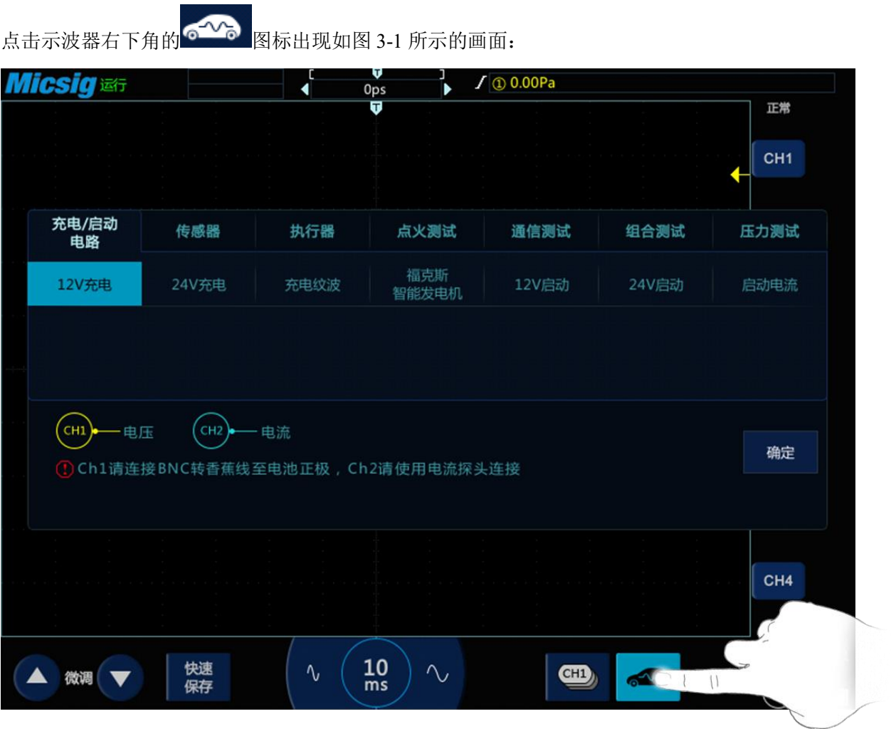
图3-1 充电/启动电路
