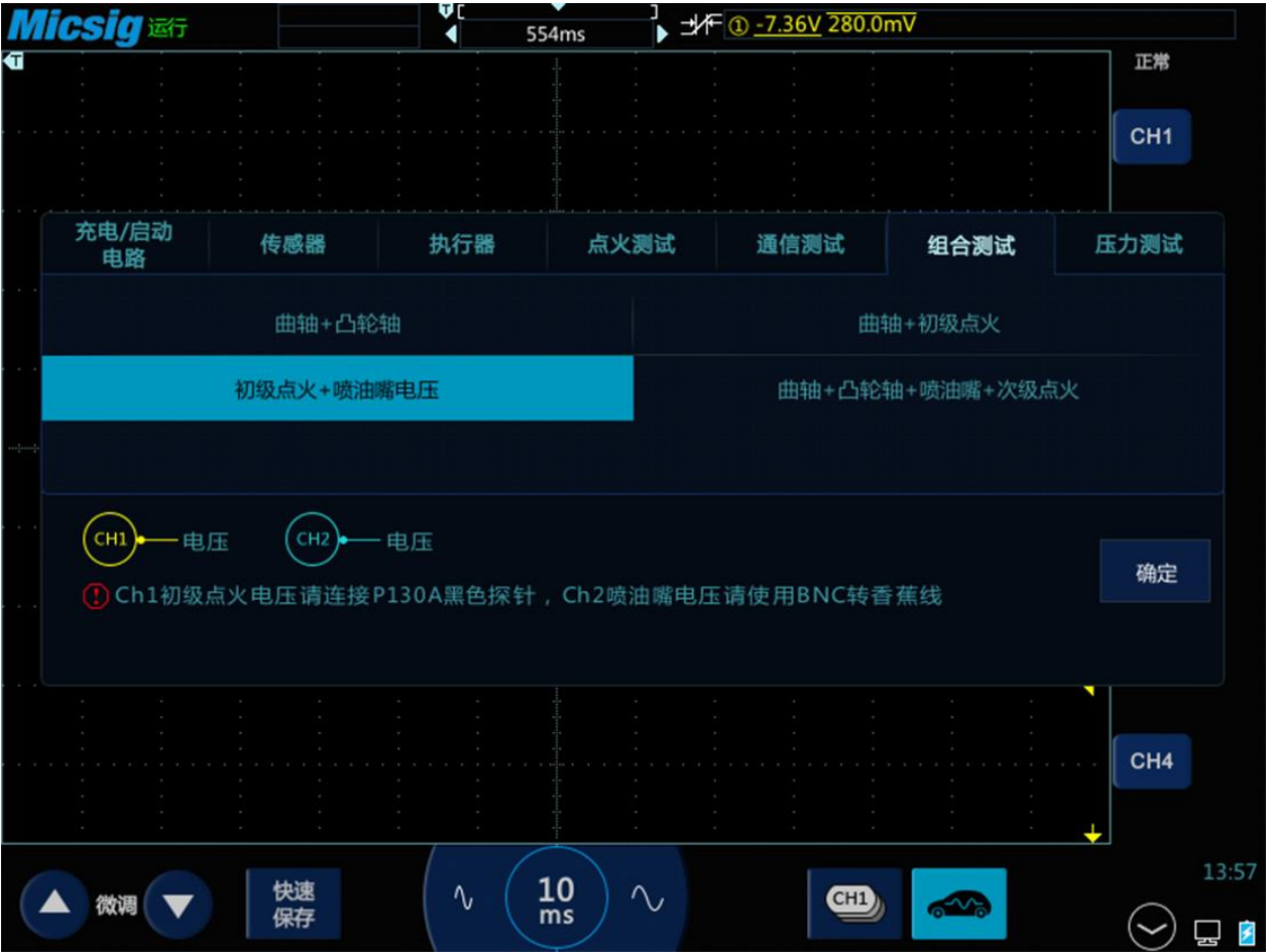
图3-57 初级点火+喷油嘴电压组合测试
