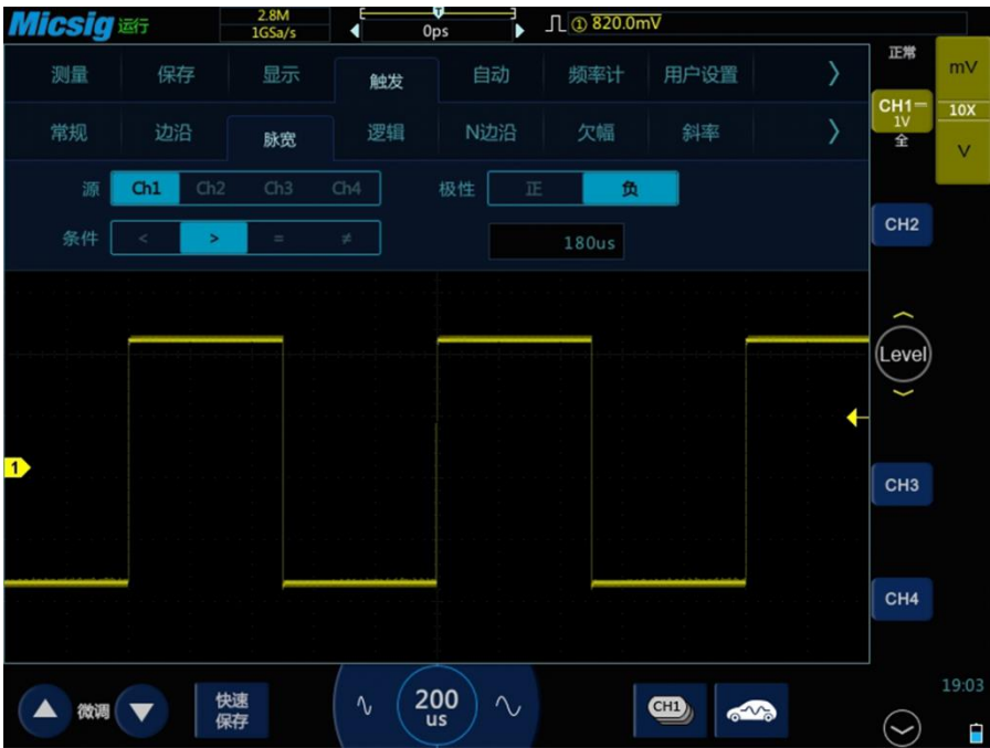
图6-13 负极性脉冲电平翻转
