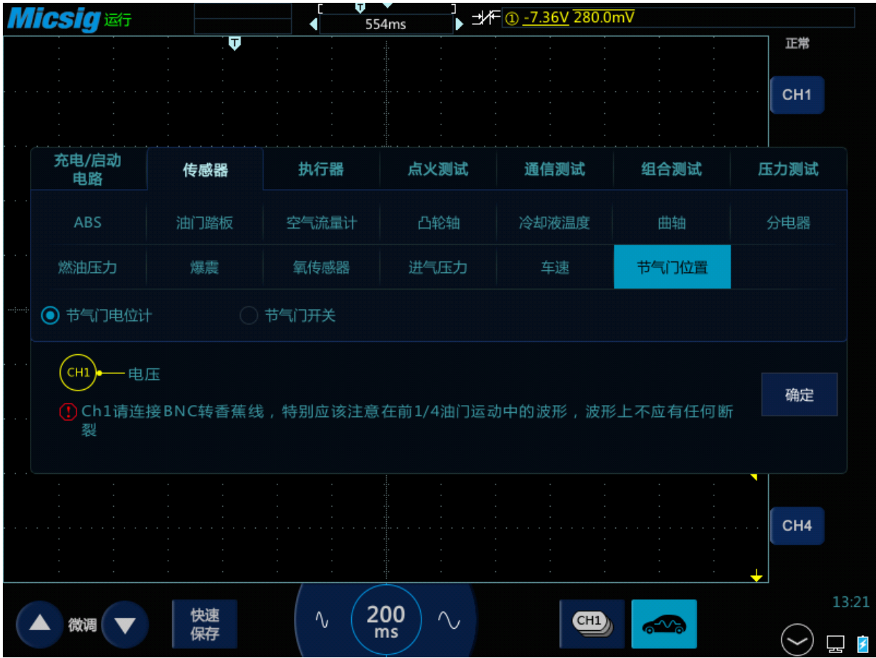
图3-27 节气门位置传感器测试
