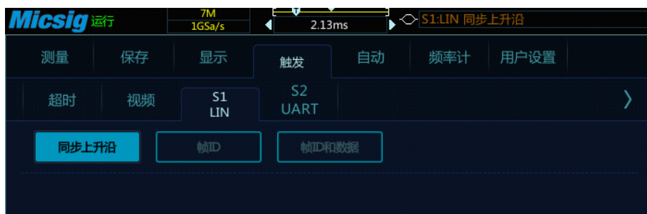
图14-10LIN 触发方式配置菜单
