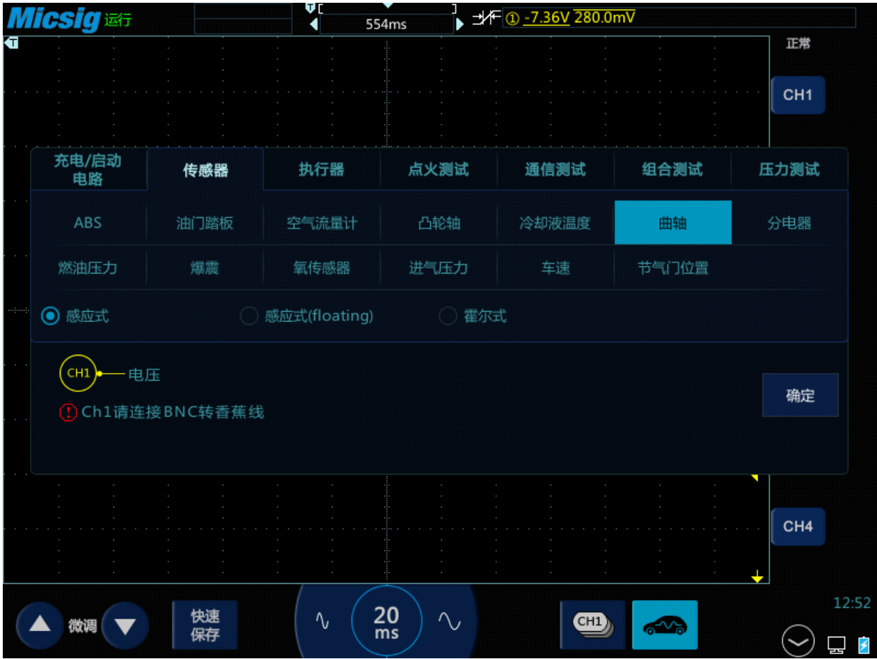
图3-17 曲轴位置传感器测试
