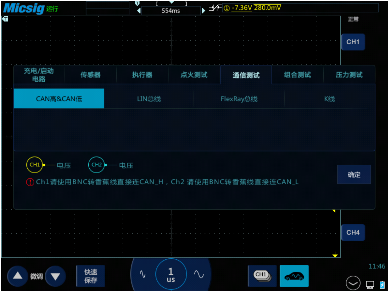
图3-49 CAN 总线测试
