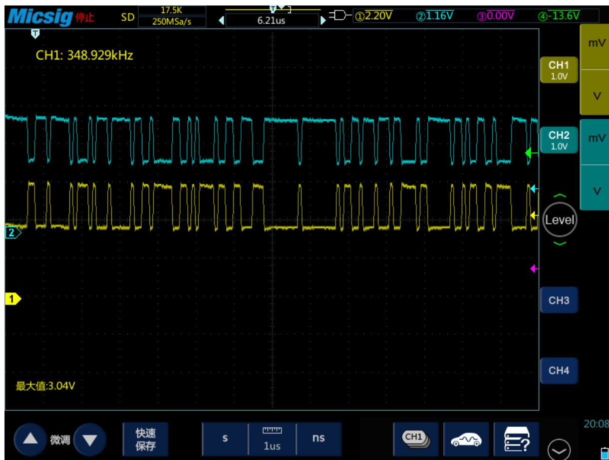
图3-50 CAN 总线实测图
