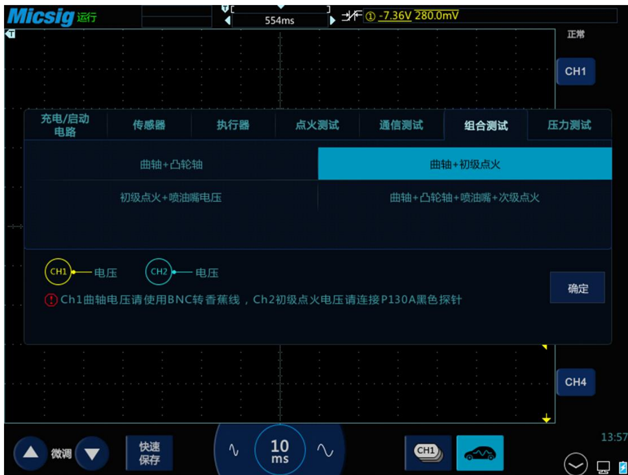
图3-56 曲轴+初级点火组合测试
