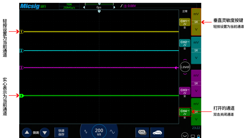
图5-4 通道的打开、关闭与切换
