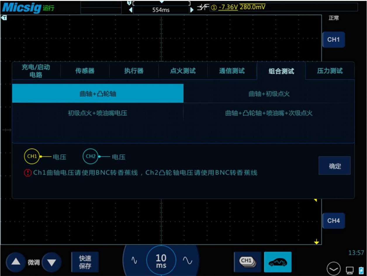
图3-55 曲轴+凸轮轴组合测试
