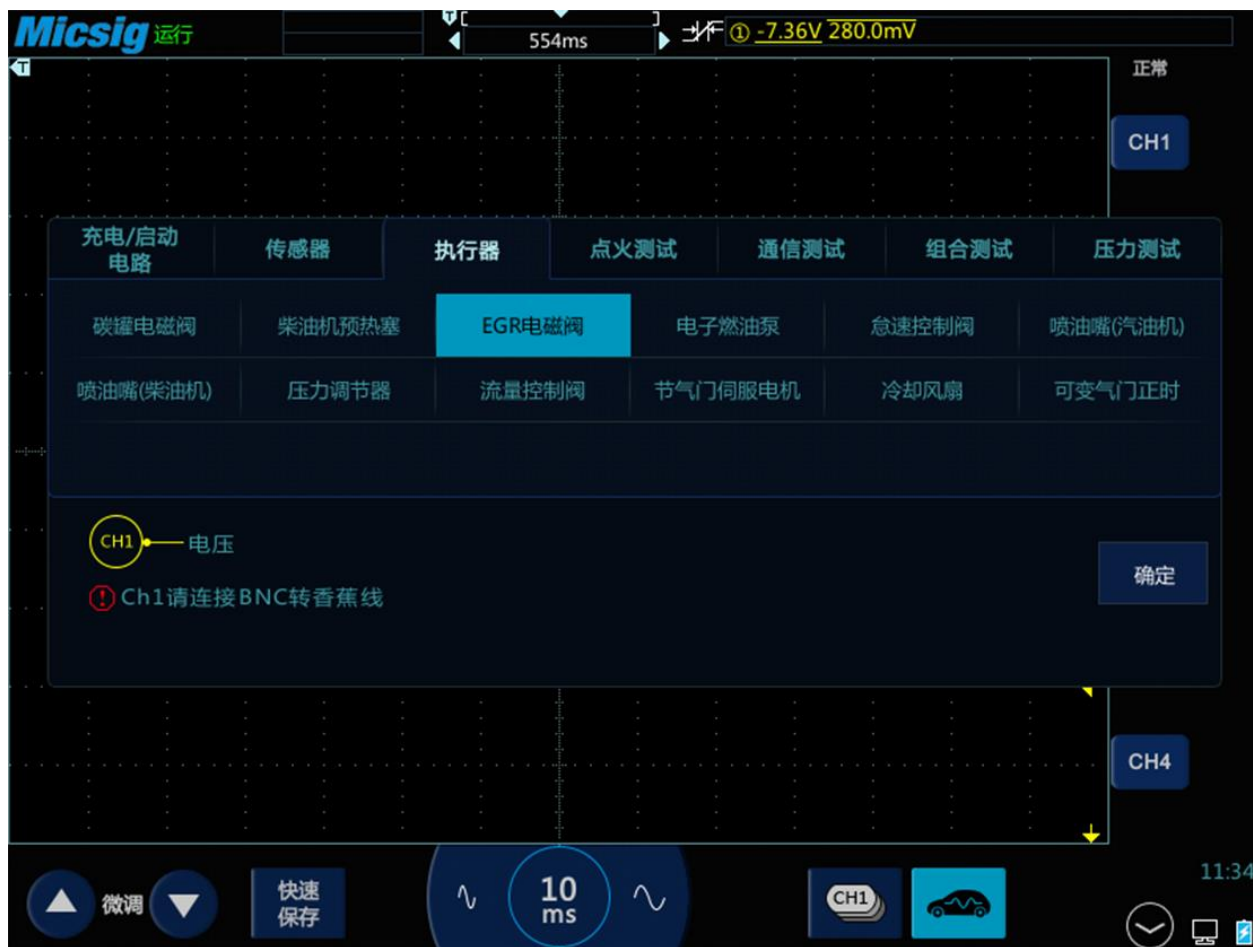
图3-32 EGR 电磁阀测试
