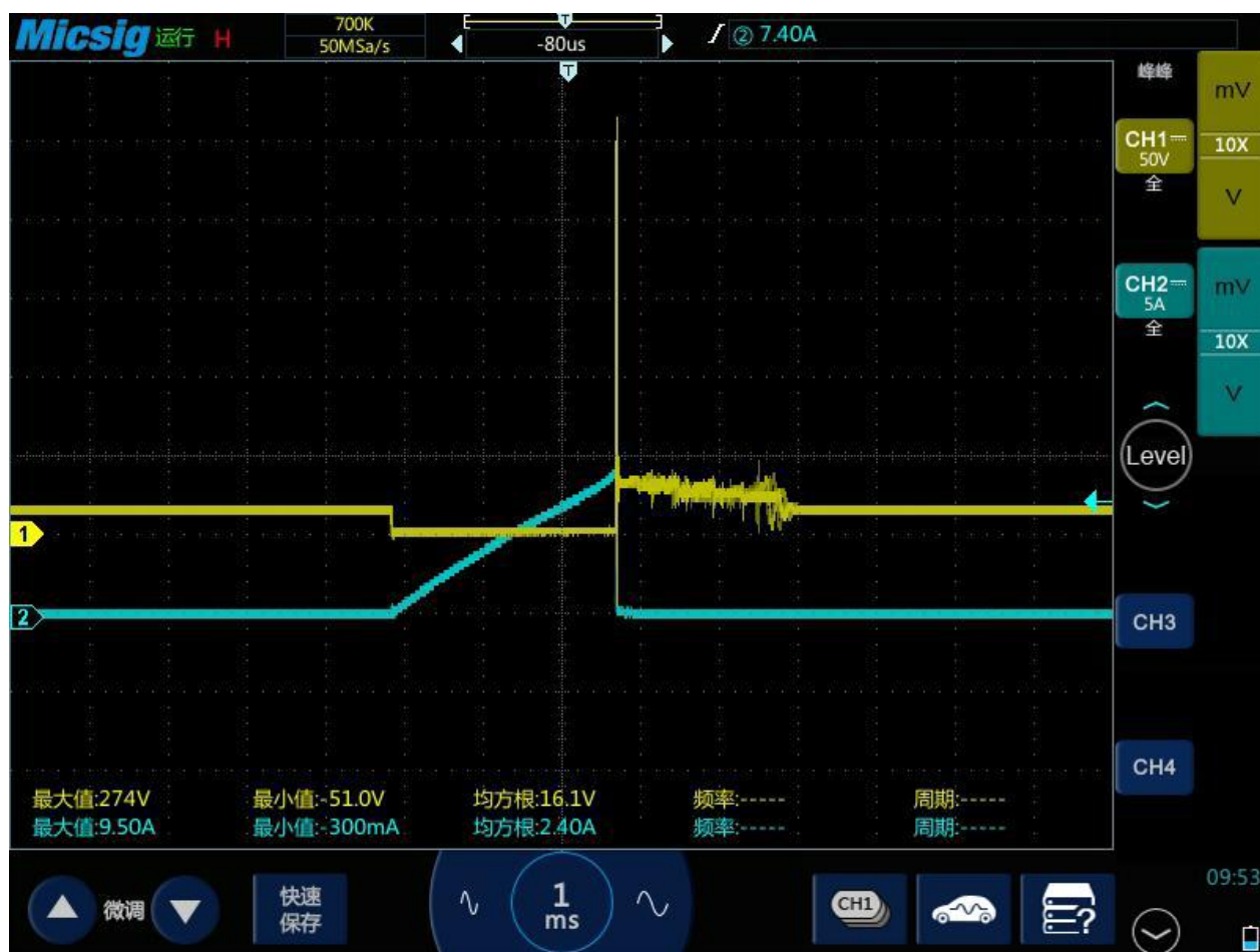
图3-48 宝马 5 系 N20 发动机初级+次级点火实测
