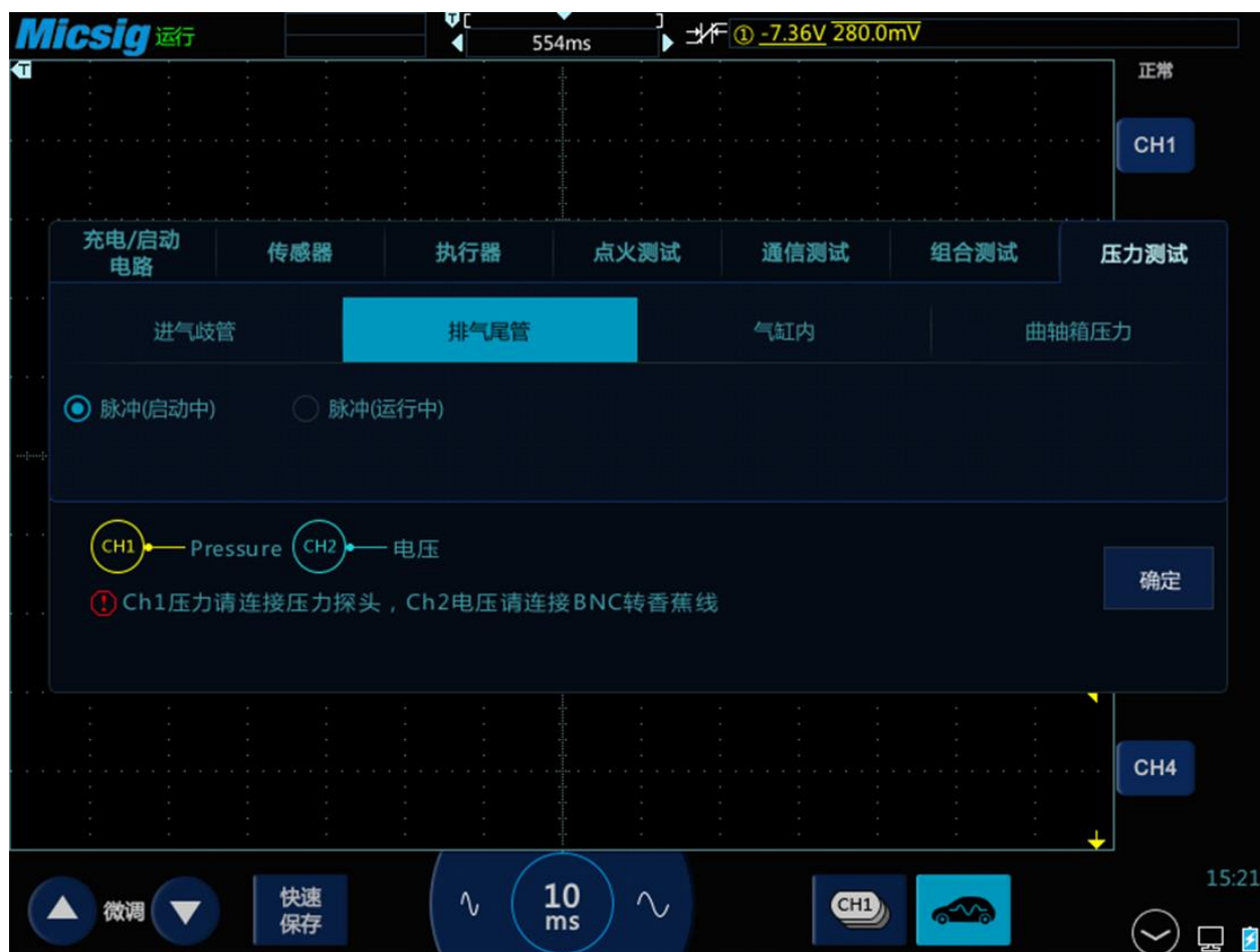
图3-60 排气歧管压力和电压测试
