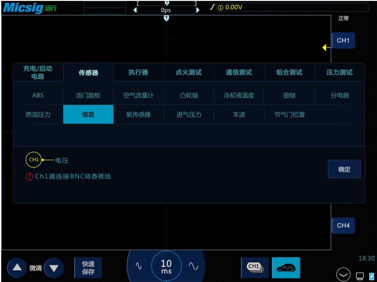
图3-21 爆震传感器测试
