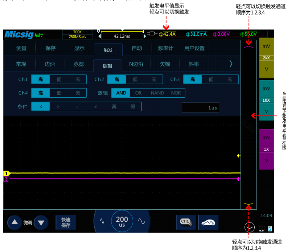
图6-20 触发电平调节
