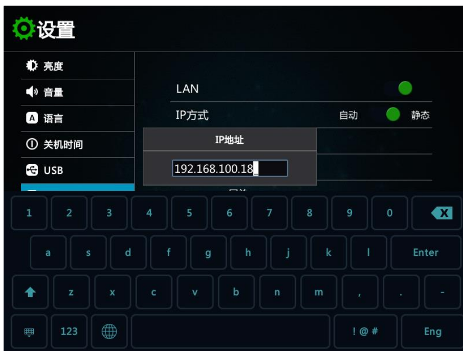
图12-4 LAN 连接设置
