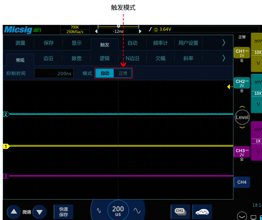
图6-5 示波器触发模式设置
