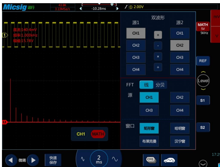
图9-5 频谱幅度为 V-Hz 示意图
