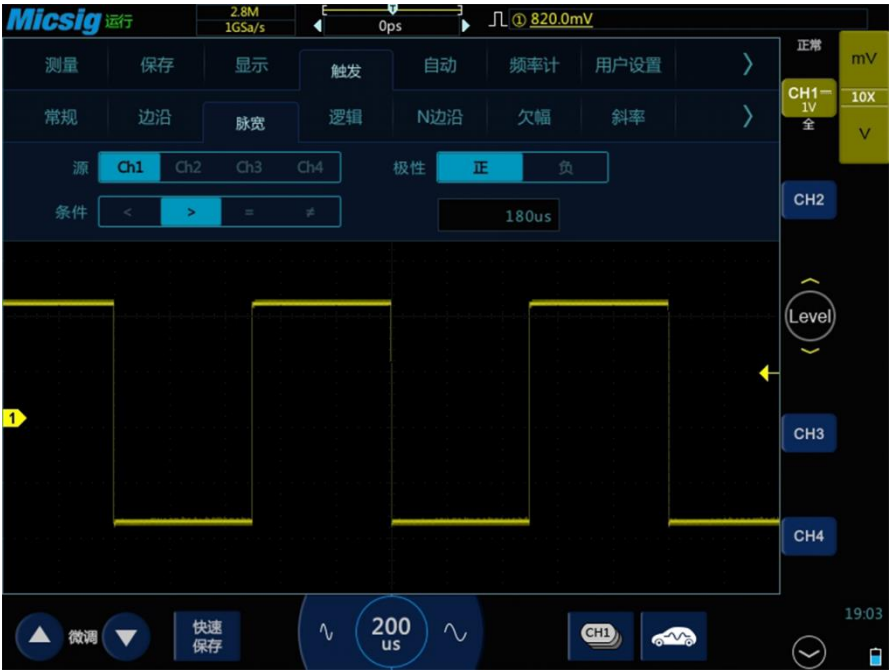
图6-2 脉冲宽度触发设置菜单
