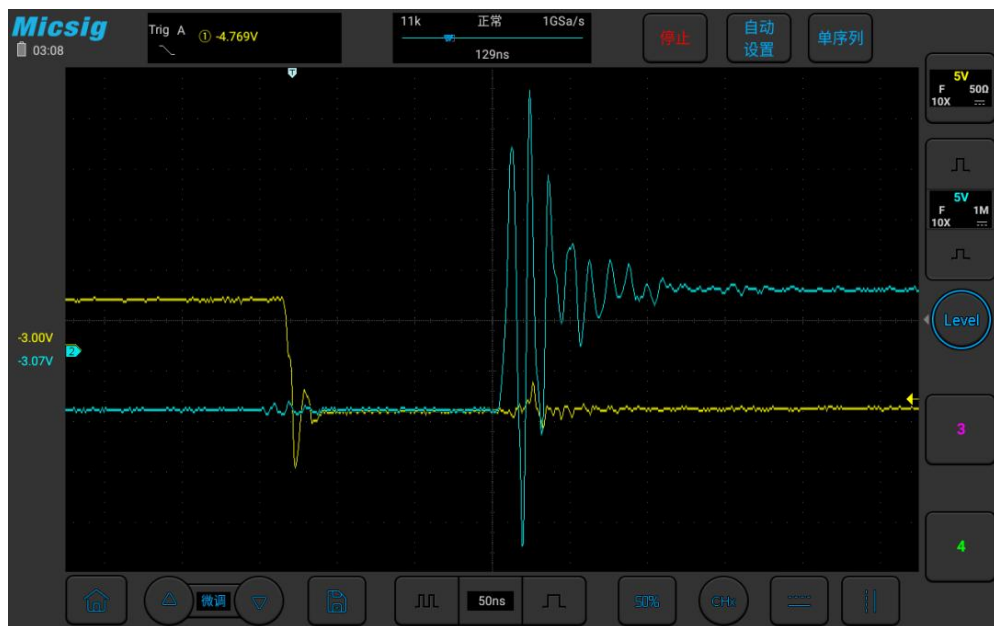
▲上管开启（黄色光隔离探头），下管关断（蓝色无源探头）
