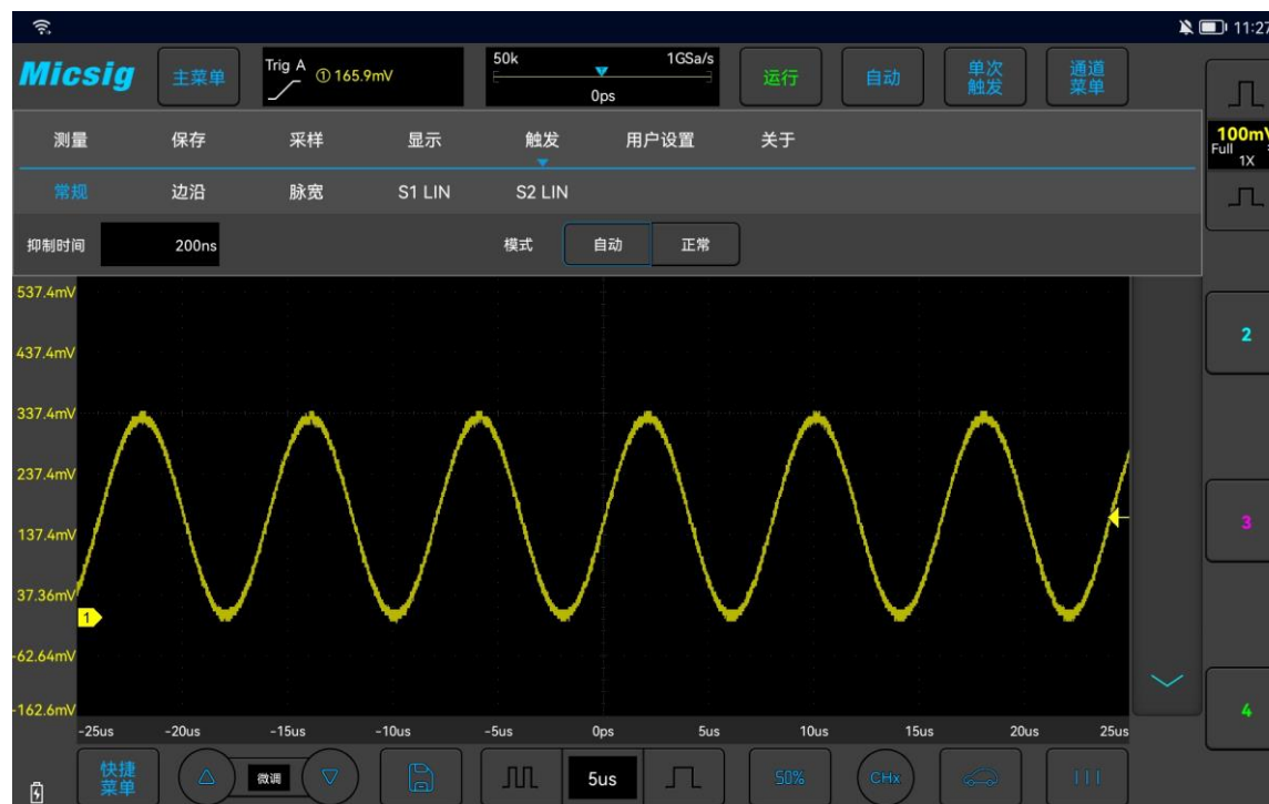
图6-5 示波器触发模式设置
