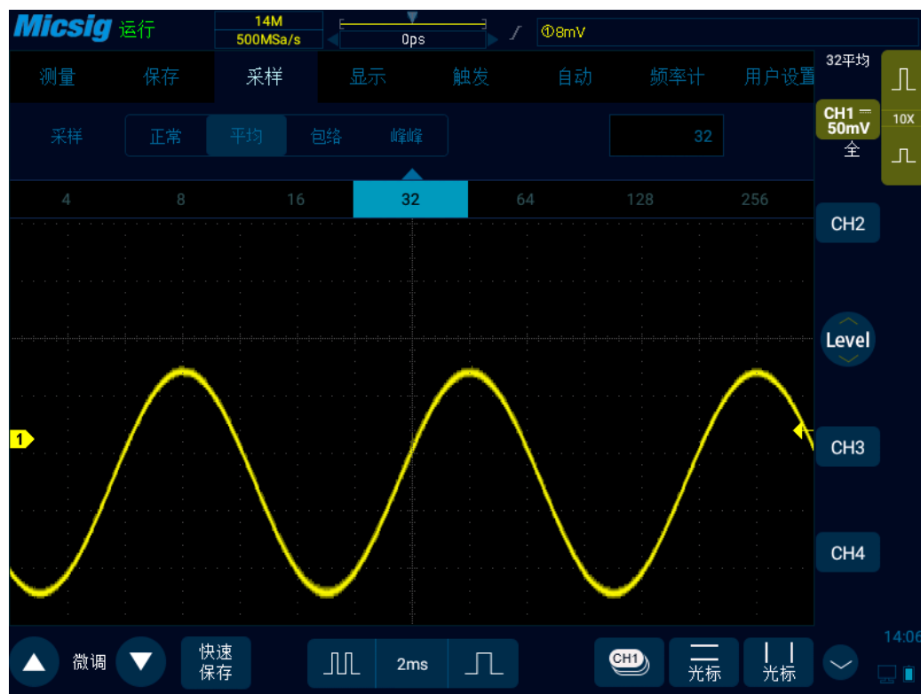
图11-7 选择平均采样模式后的波形，平均数 32
