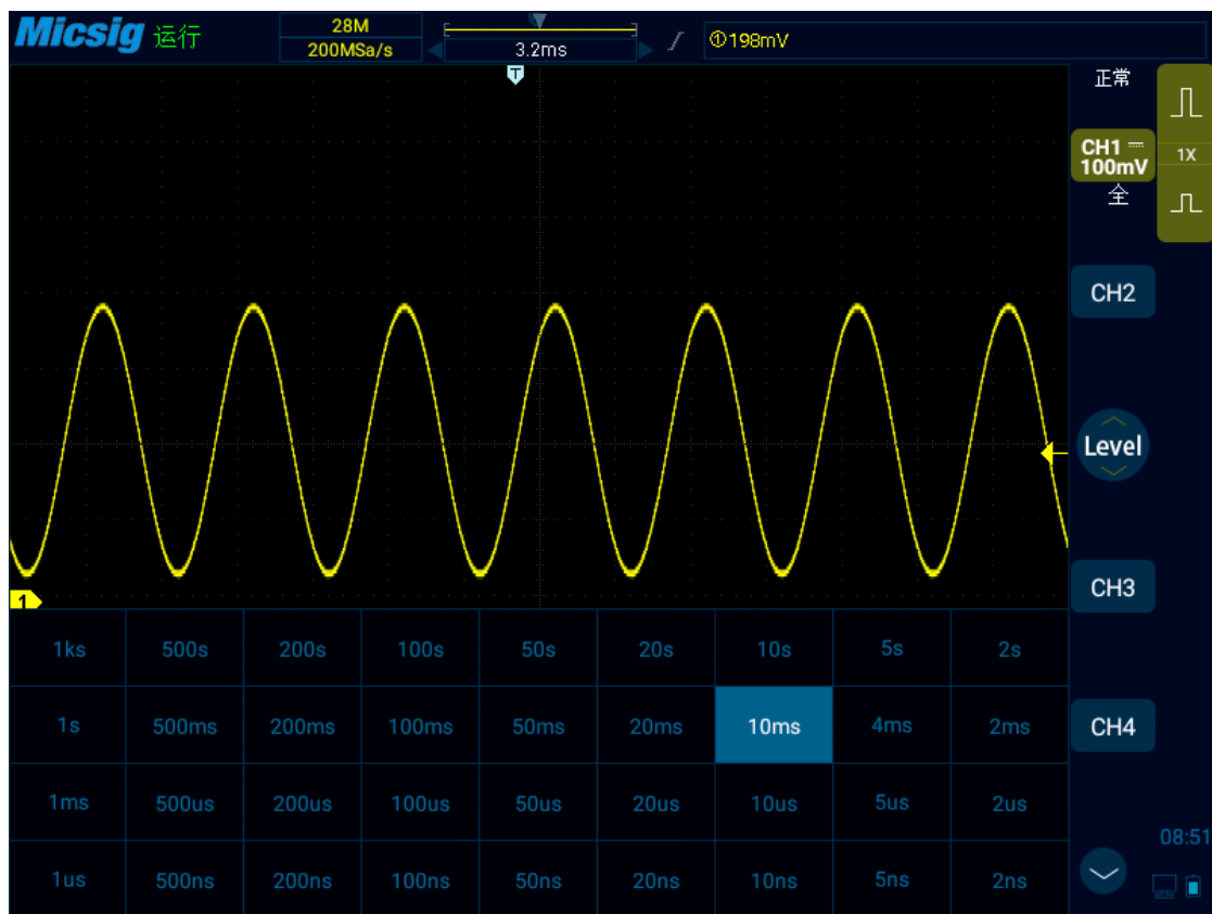
图4-4 水平时基旋钮
