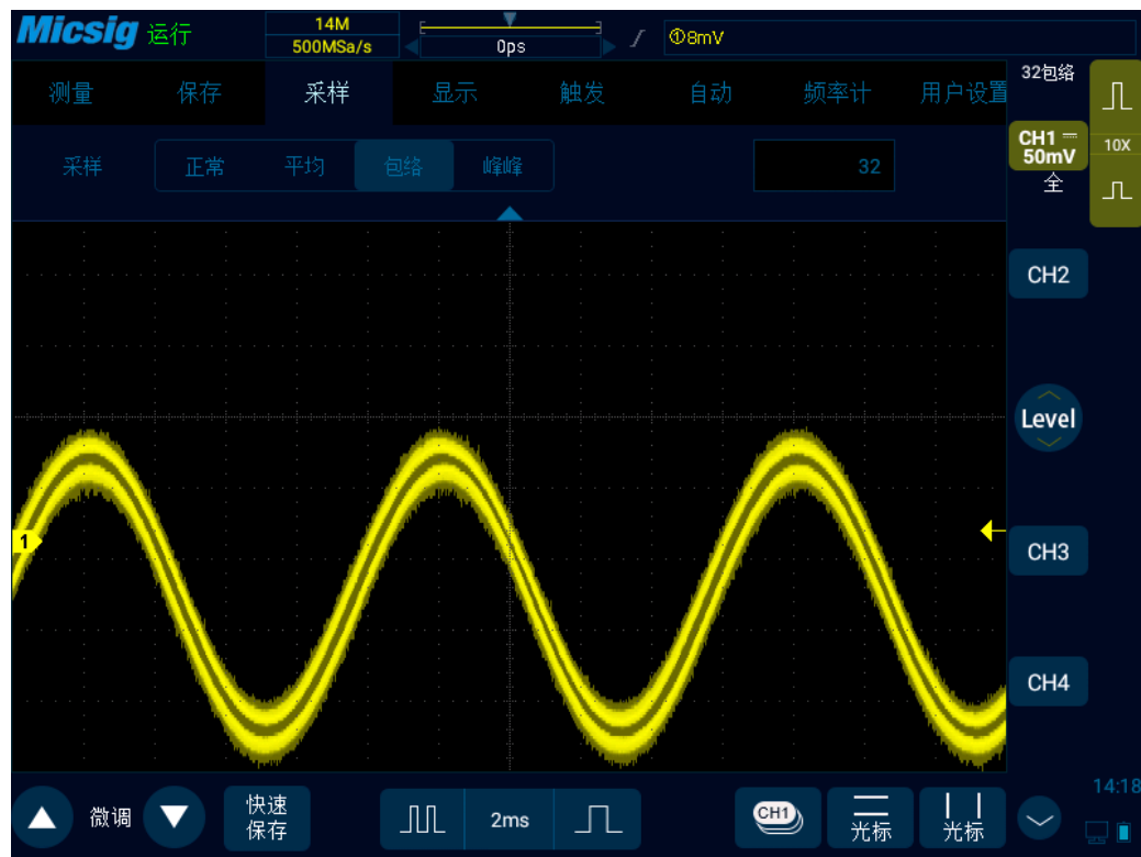
图11-8 包络采样模式（32）下的调幅信号
