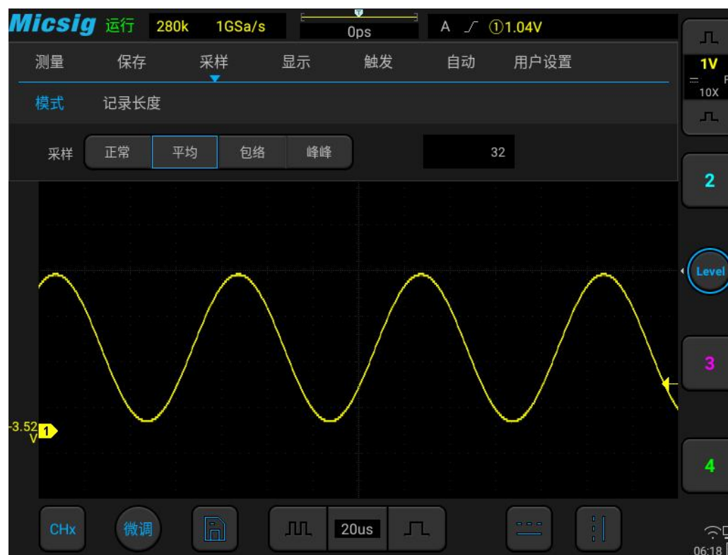
图 11-7 选择平均采样模式后的波形，平均数 32
