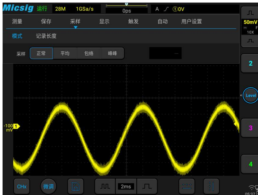
图 11-5 带毛刺的正弦波，正常采样模式
