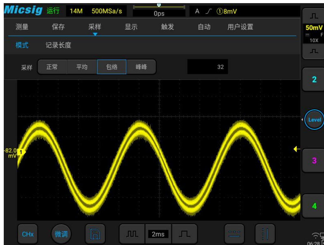
图 11-8 包络采样模式（32）下的调幅信号
