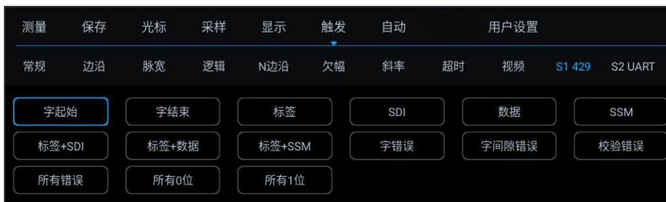
图 13-27 ARINC429 触发方式配置菜单
