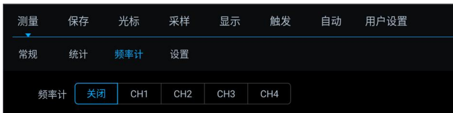
图 8-14 频率计测量菜单打开
