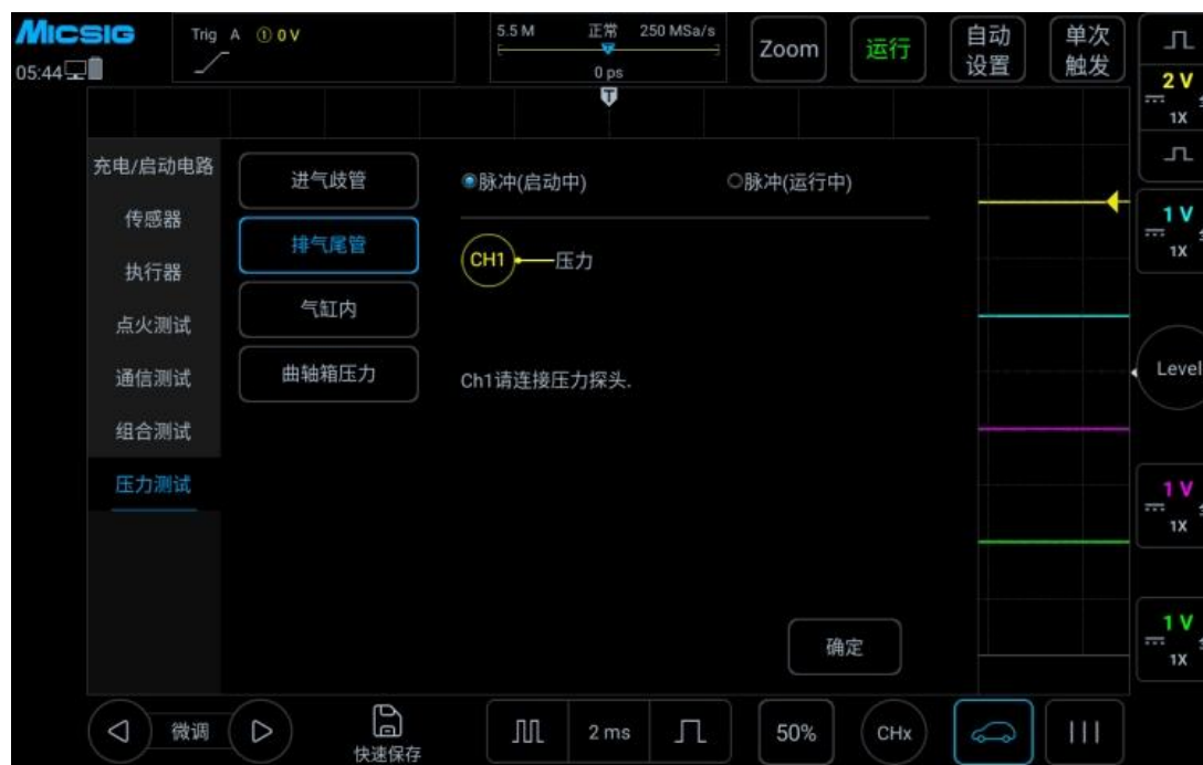
图 3-60 排气尾管压力测试
