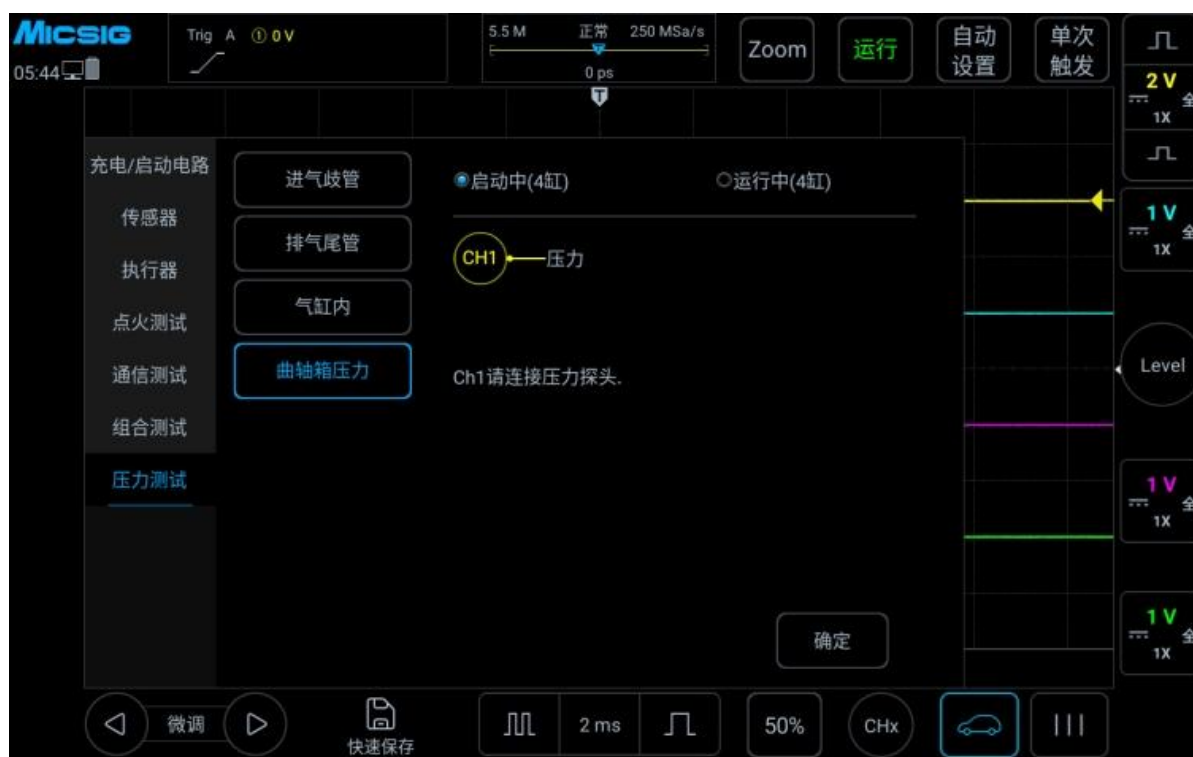
图 3-62 曲轴箱压力测试
