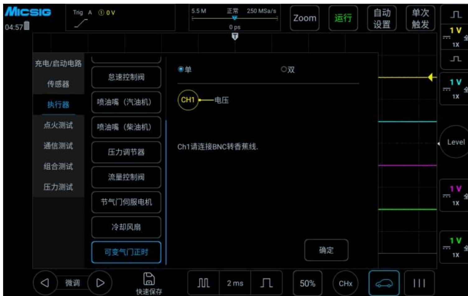
图 3-42 可变气门正时测试
