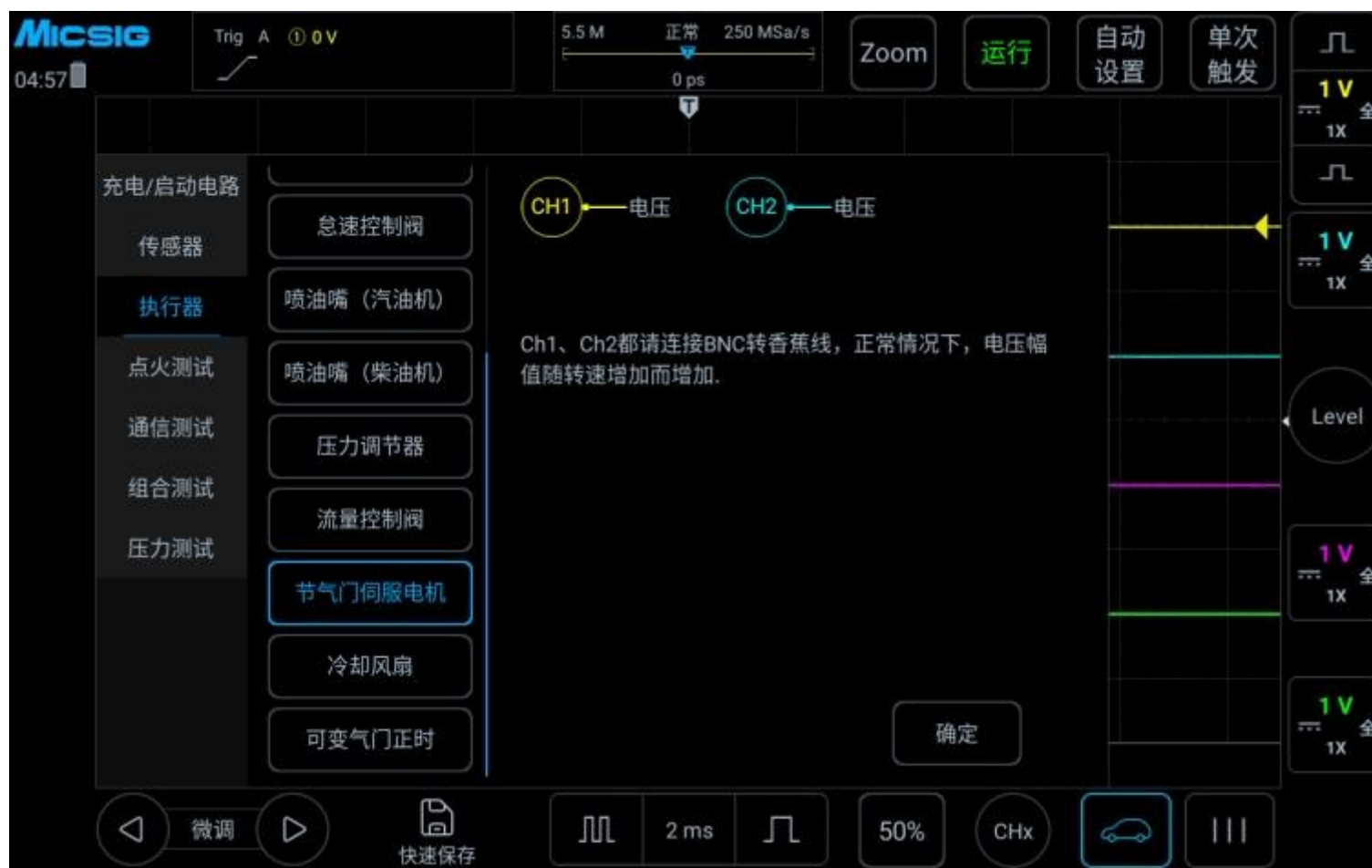
图 3-39 节气门伺服电机测试
