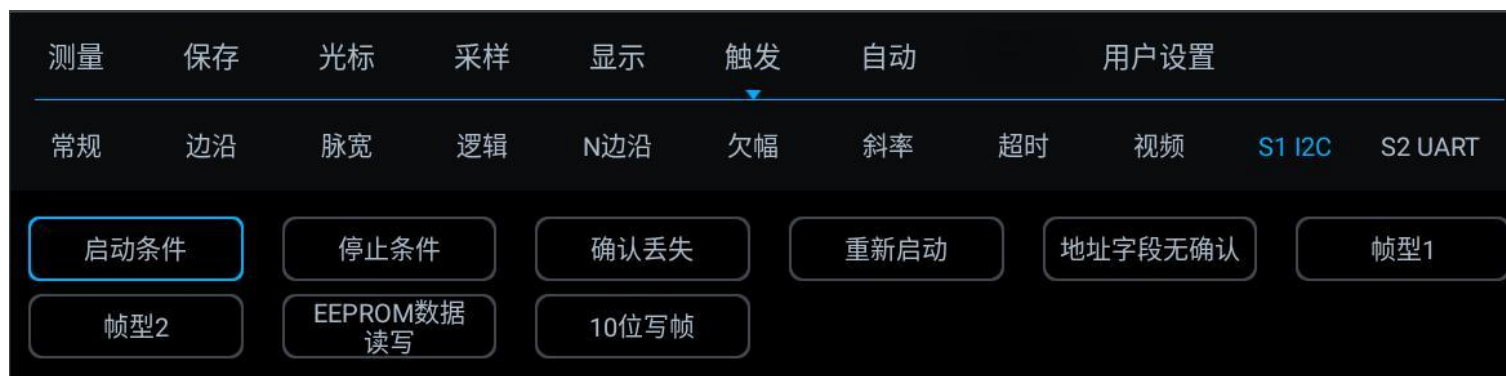
图 13-23 I2C 触发方式配置菜单
