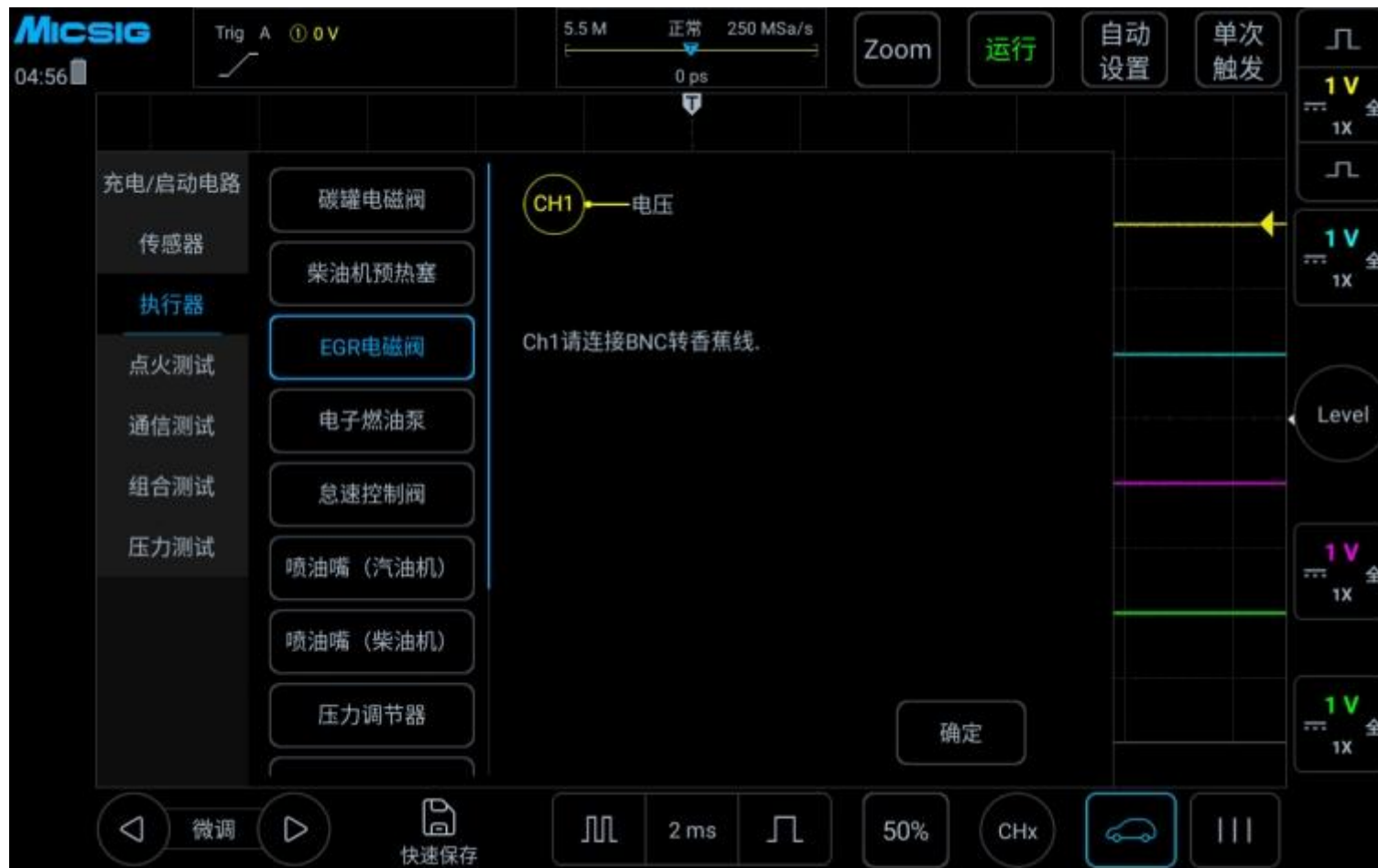
图 3-32 EGR 电磁阀测试
