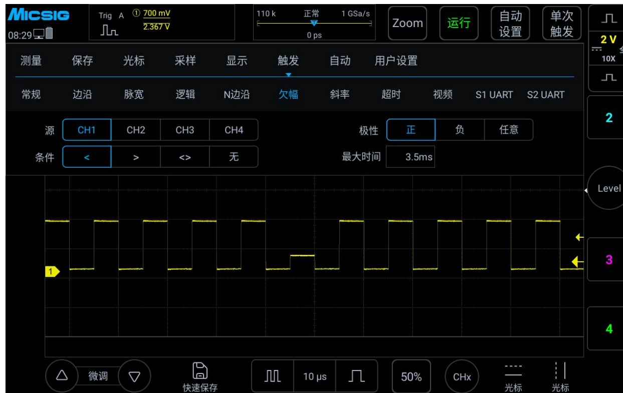
图 7-25 欠幅触发设置菜单
