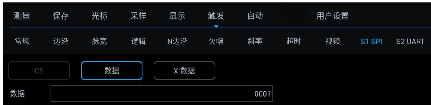
图 13-19SPI 触发方式配置菜单
