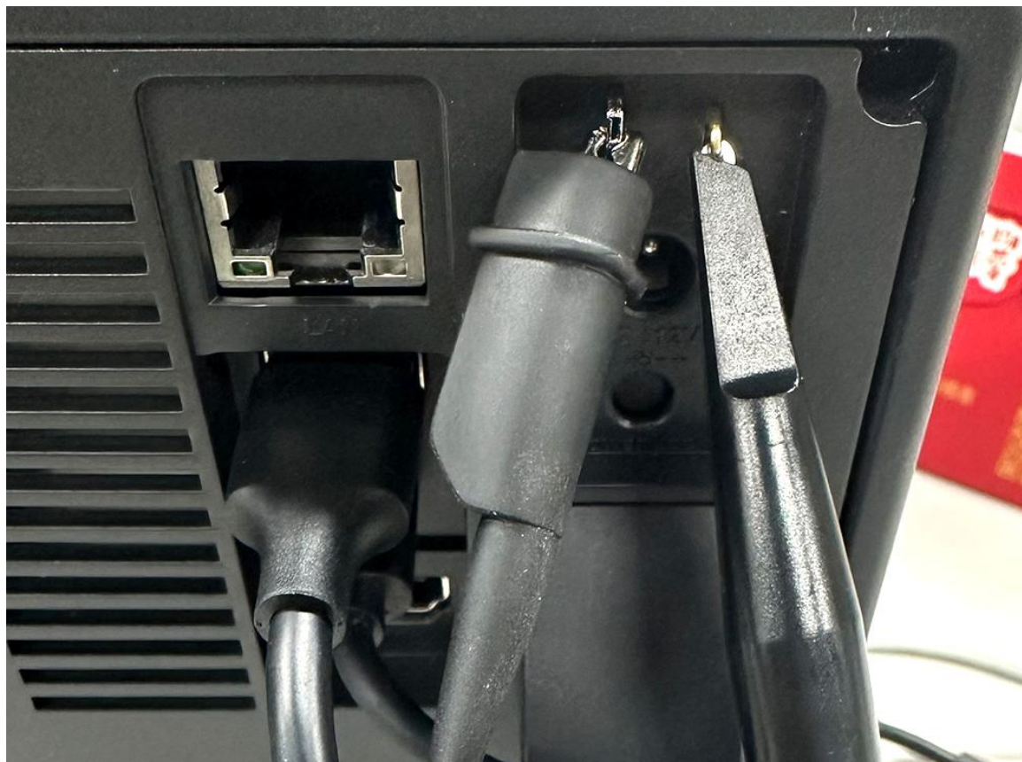
图 2-11 探头连接方式
