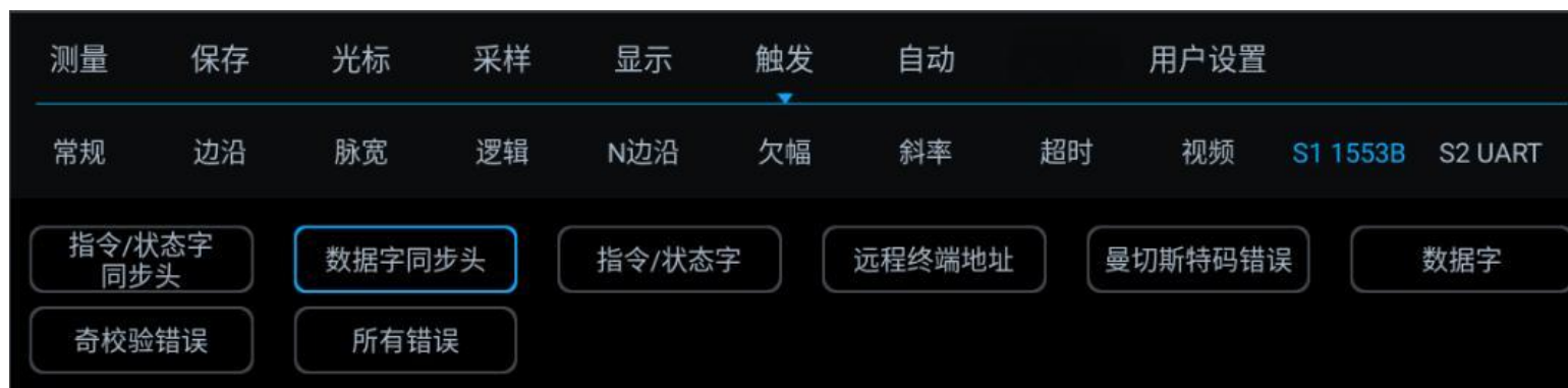
图 13-31 1553B 触发方式配置菜单
