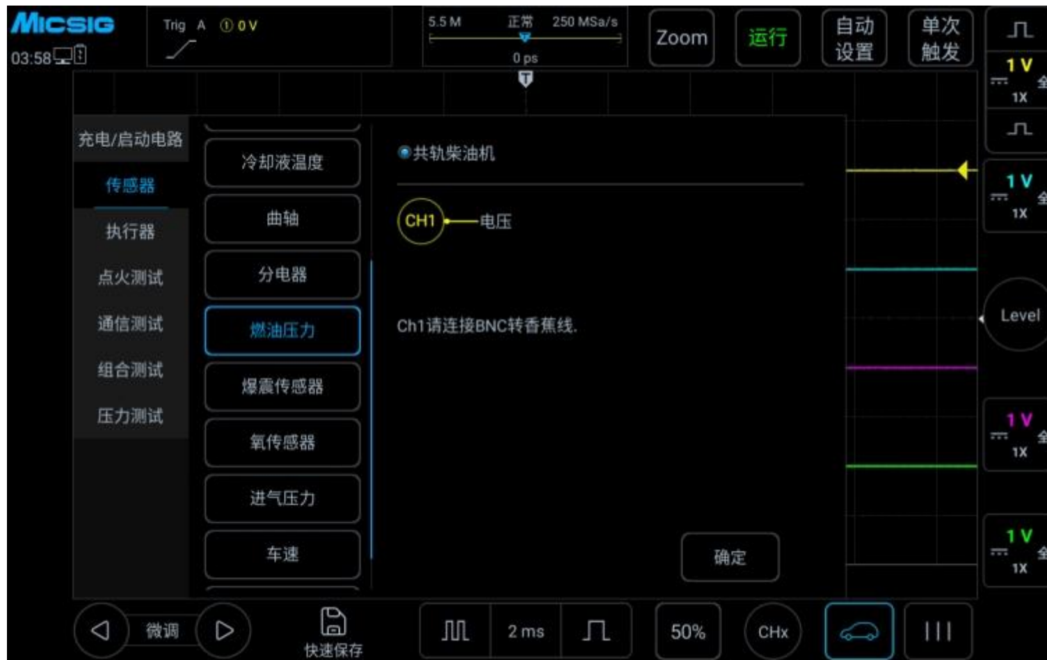
图 3-20 燃油压力传感器测试
