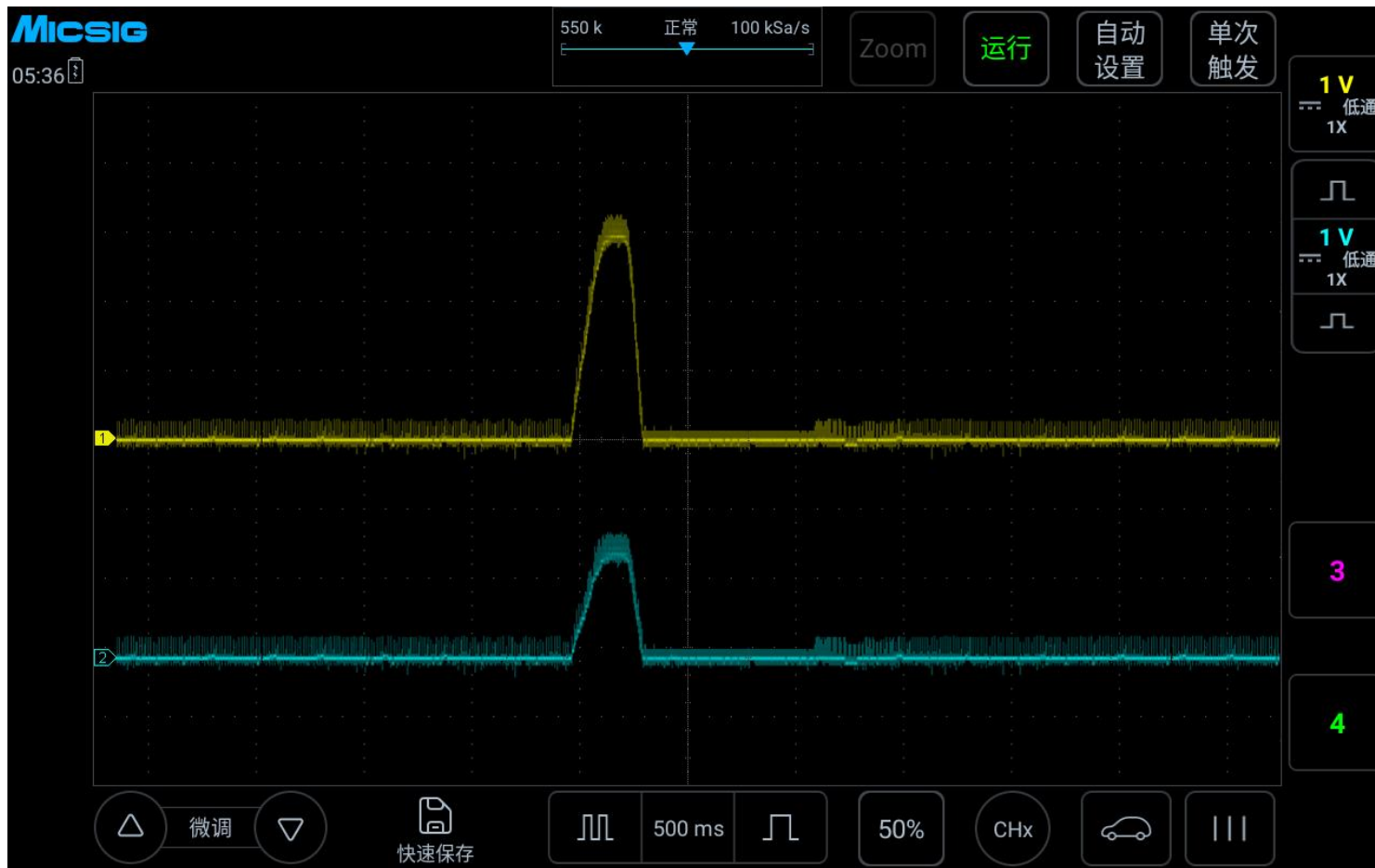
图 3-12 油门踏板传感器的实测图
