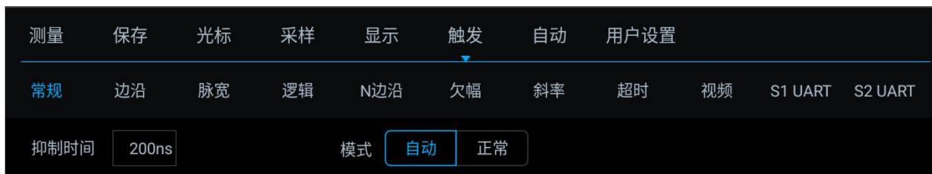
图 7-5 示波器触发模式设置
