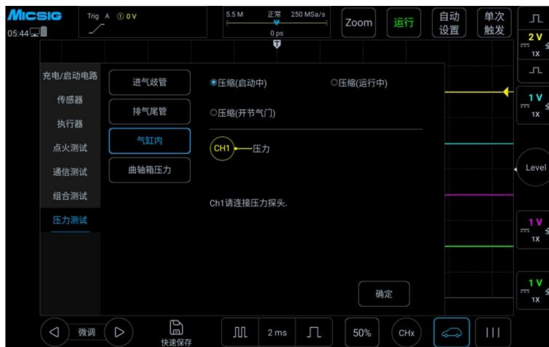
图 3-61 气缸内压力测试
