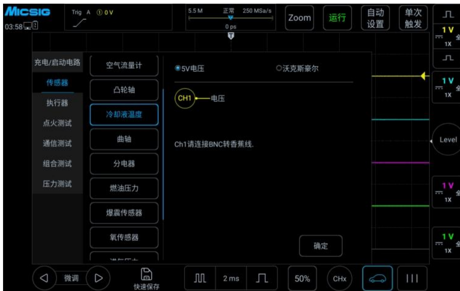
图 3-16 冷却液温度传感器测试
