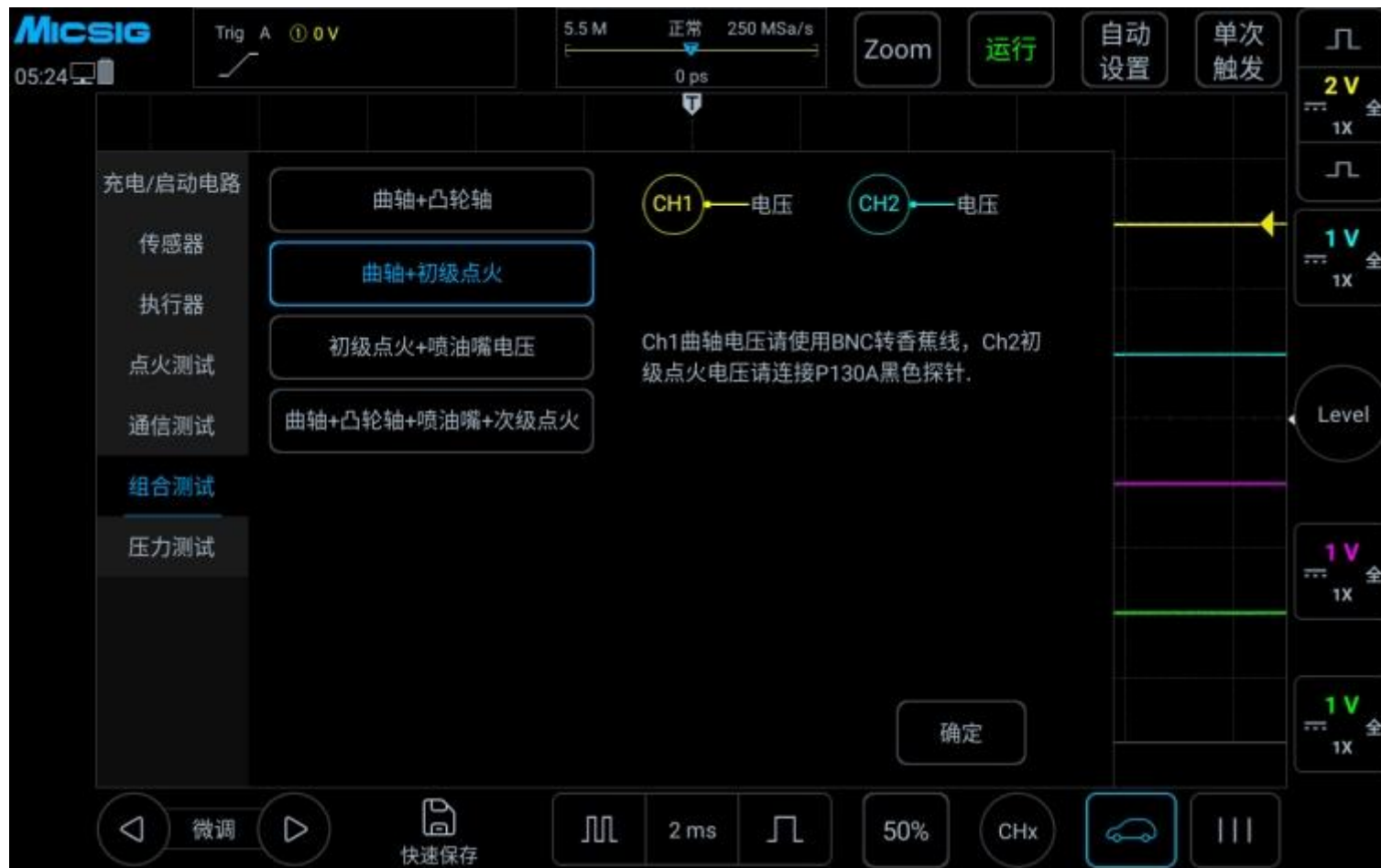
图 3-56 曲轴+初级点火组合测试
