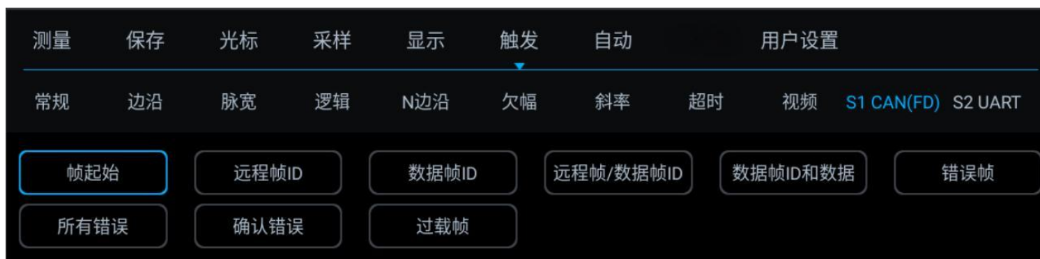
图 13-15CAN 触发方式配置菜单
