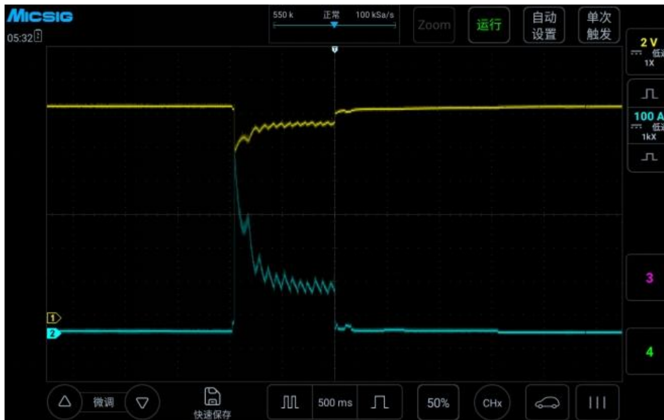
图 3-7 启动电压与电流的实测图
