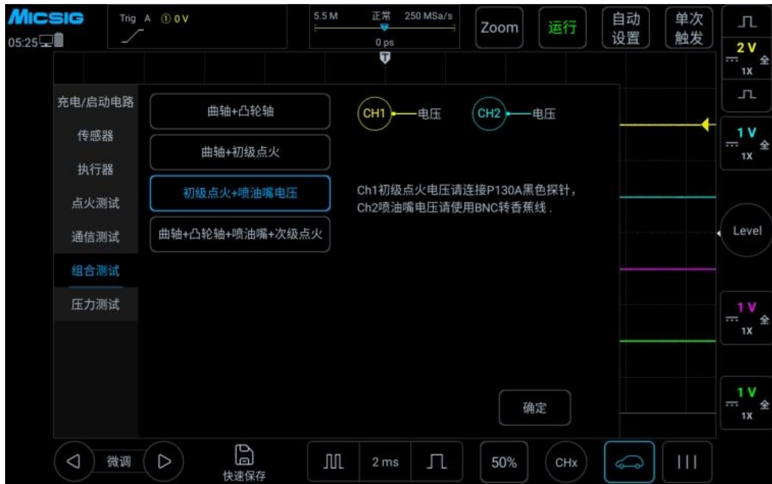
图 3-57 初级点火+喷油嘴电压组合测试
