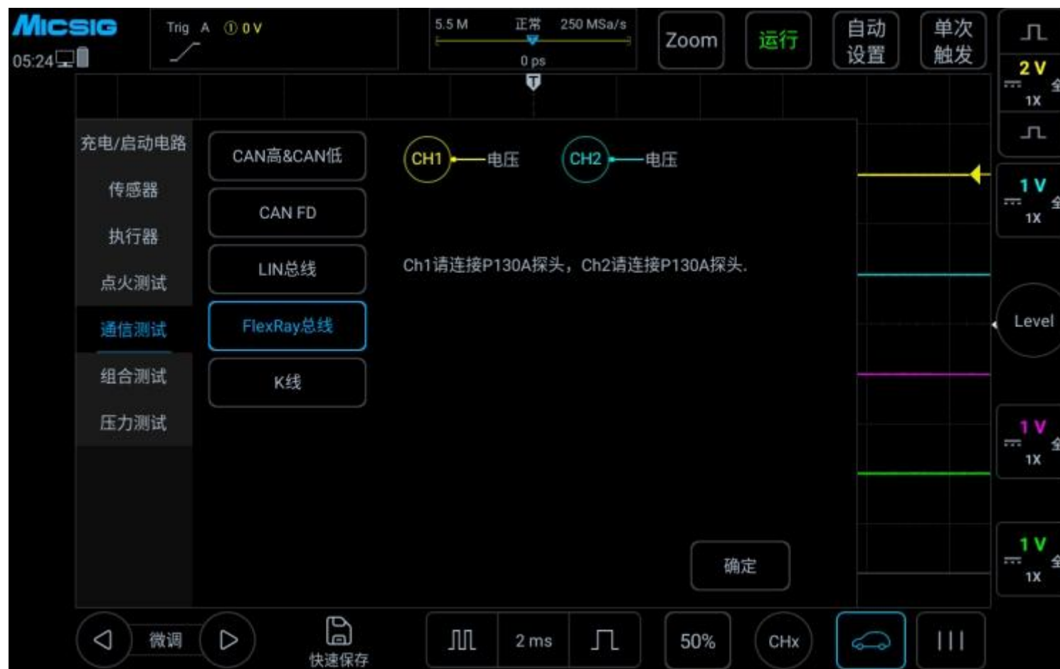
图 3-53 FlexRay 总线测试
