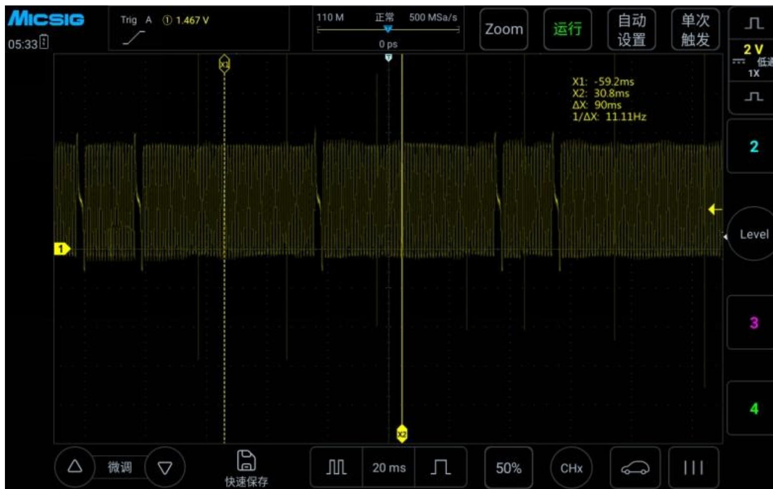
图 3-18 曲轴位置传感器（感应式）的实测图
