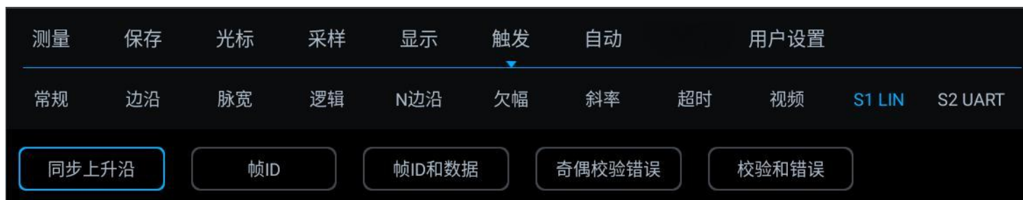
图 13-11 LIN 触发方式配置菜单
