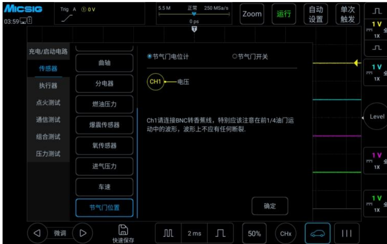
图 3-27 节气门位置传感器测试
