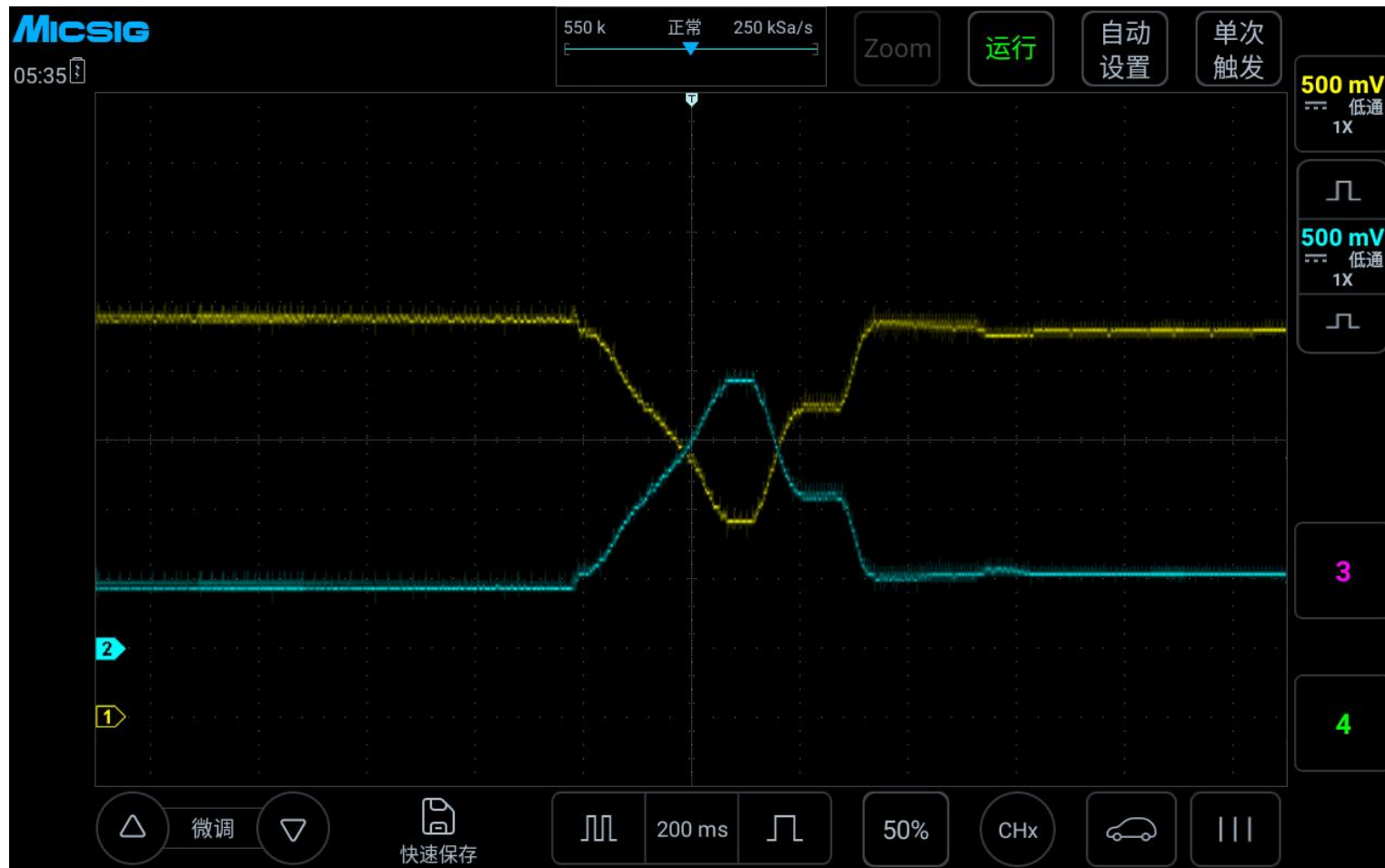
图 3-28 节气门位置传感器实测图
