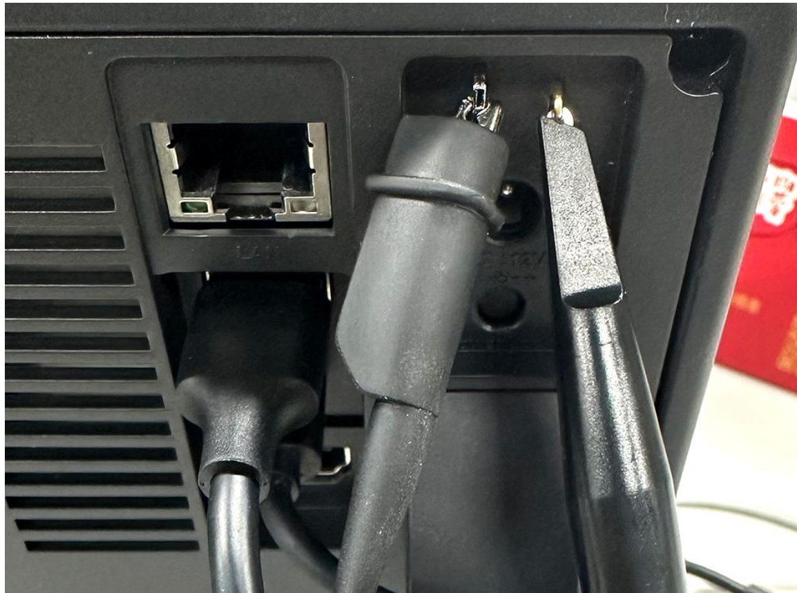
图 2-13 探头连接方式
