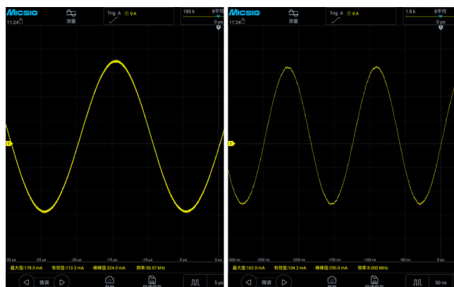
CP3008: 将 113mV 的被测信号从 50 kHz 调整至 8 MHz, 电流值仅衰减至原来的 92%。测量高频信号时, 精度依然在线。
