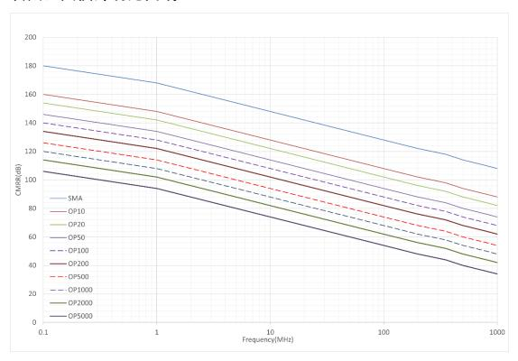
上图展示不同型号衰减器 (OdB) 在各个频率下的共模抑制能力。
