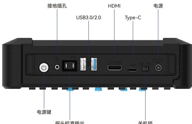
▶ 电源键、接地插头、探头校准输出、USB3.0/2.0、HDMI、Type-C、电源、关机锁（注意：首次使用请切换到 ON）
