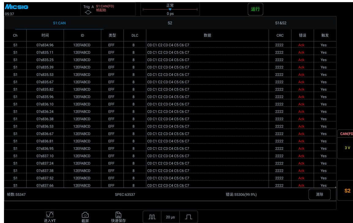
图 11-17 CAN 总线解码文本模式
