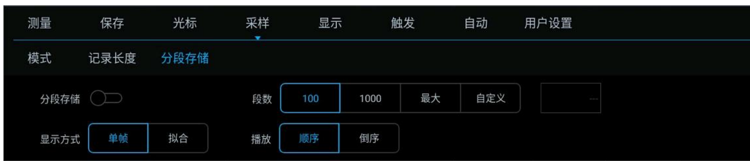
图 10-10 分段存储设置
