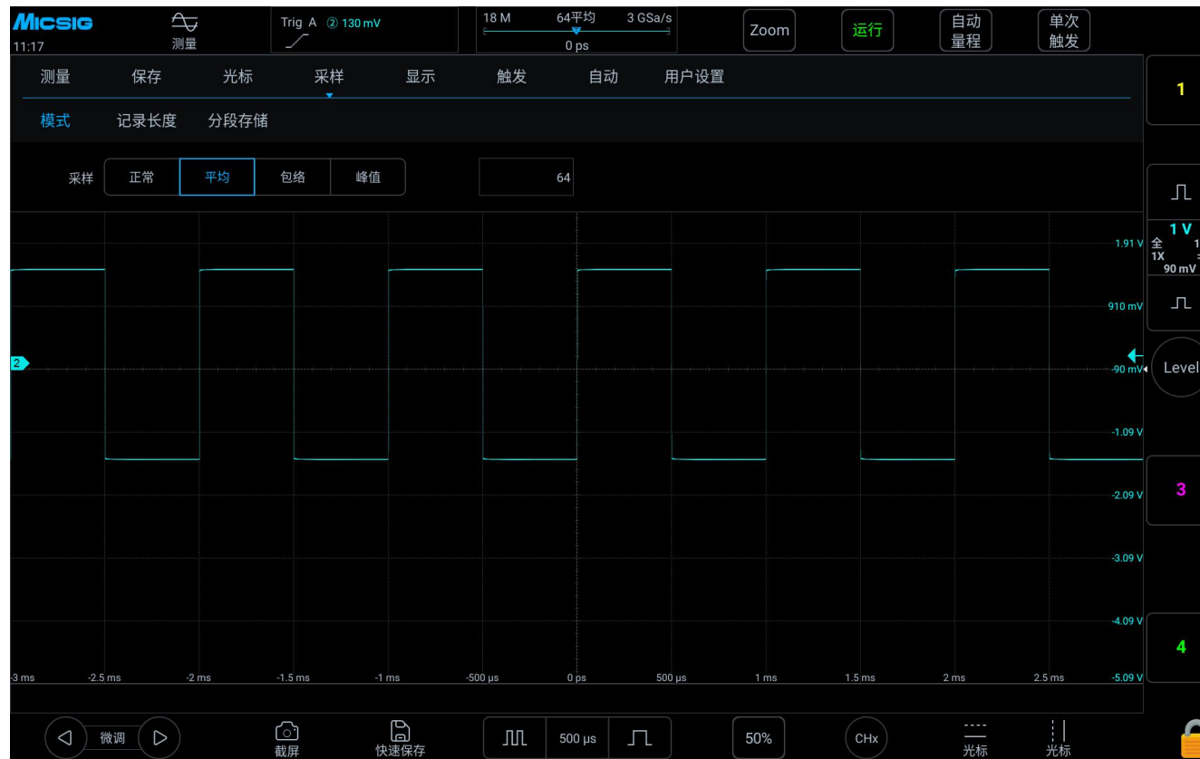
图 10-7 选择平均采样模式后的波形，平均数 64
