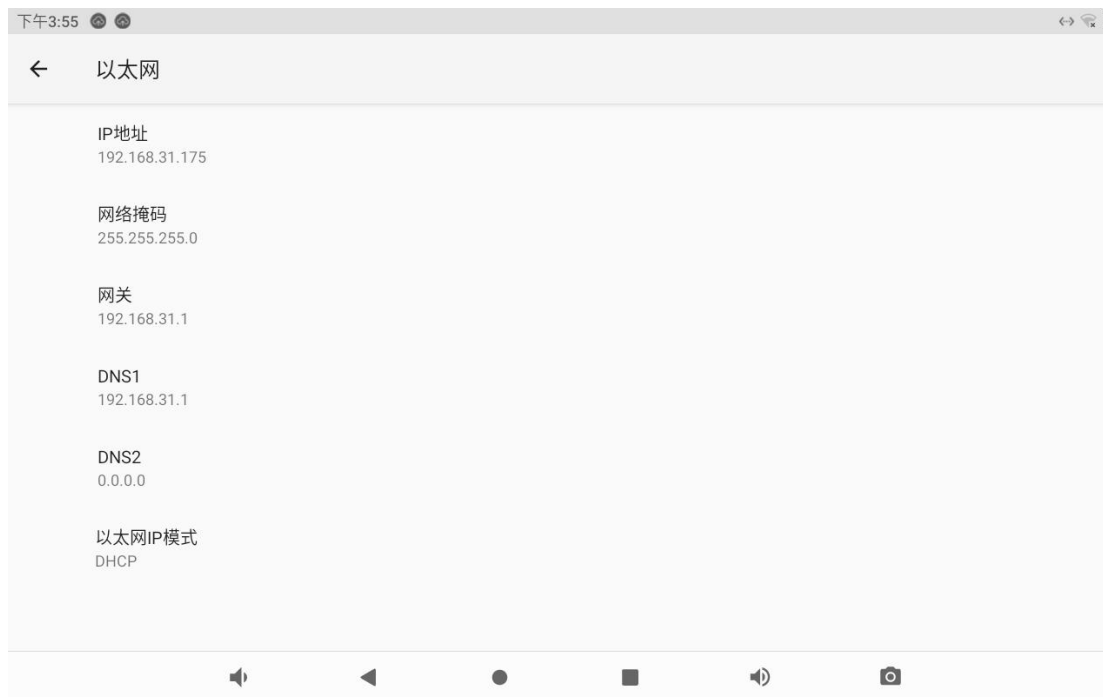
图 12-6 以太网连接设置
