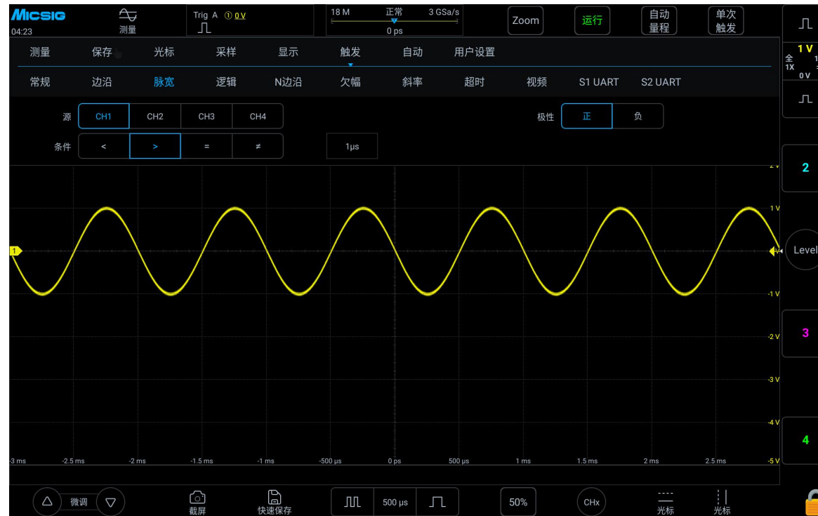
图 5-14 脉冲宽度触发设置菜单
