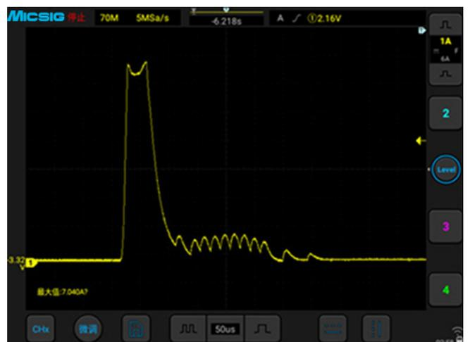
电源适配器启动时的浪涌电流波形。
